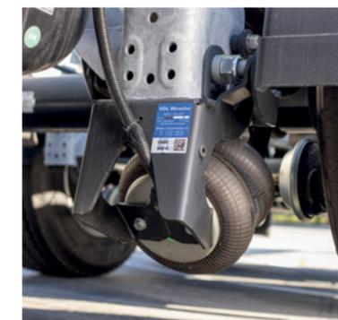
Die **Liftachse\*** als Anfahrhilfe verlängert den Radstand und verstärkt damit den Druck auf die Antriebsachse. Unbeladen in gelifteter Position reduziert sich der Reifenverschleiß.
