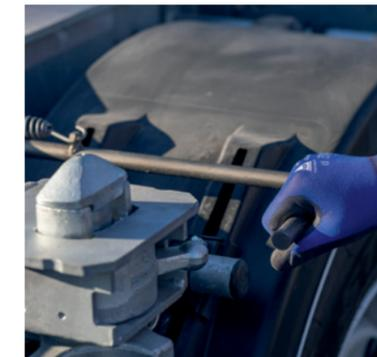
**Manuelle Verriegelung** für den pneumatischen Heckausschub.
