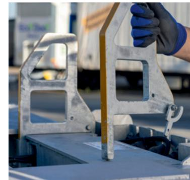
Leicht auswechselbare **Containerführungen** für Tunnelcontainer am Frontbalken.
