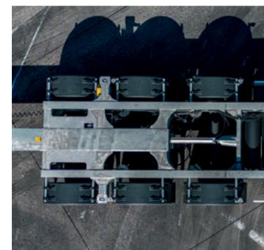
Lange Lebensdauer: Schmitz Cargobull Containerchassis werden **aus hochfesten Stahlprofilen** aufgebaut und systematisch gegen Korrosion geschützt.
