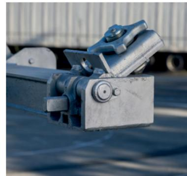
**Klappverriegelung als PIN-Verriegelung** für Tunnelcontainer am Frontbalken.
