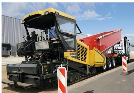
Der **klappbare Unterfahrerschutz** bietet hohe Bodenfreiheit und ist manuell bedienbar, optional erhältlich mit Federmechanik für einfaches Handling oder in pneumatischer Ausführung für erhöhte Sicherheit und Zeitersparnis.
