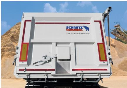
Die aufliegende **Pendelklappe** ist für Teilentladungen geeignet und optional mit Schieber erhältlich. Die Kombitür mit Pendel- und Türfunktion oder Pendelklappe mit Schütte erweitern das Angebot.
