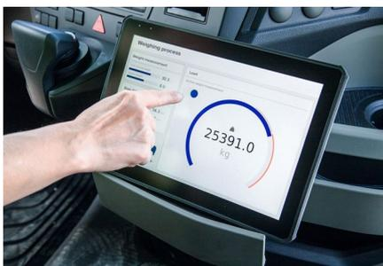
Das **ab Werk kalibrierte Onboard-Wiegesystem\*** ist in 5 Sekunden einsatzbereit und kann via Bildschirm oder beSmart App bedient werden. Eine stationäre Kontrollwaage muss nicht angefahren werden, die Wiegedaten sind sofort verfügbar.
