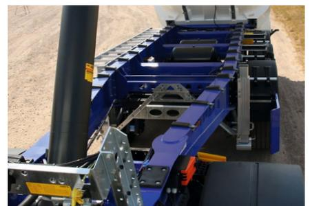
Das **verwindungssteife Stahl-Fahrgestell** mit verbessertem Korrosionsschutz in lackierter oder verzinkter Ausführung sorgt für bestmöglichen Werterhalt.
