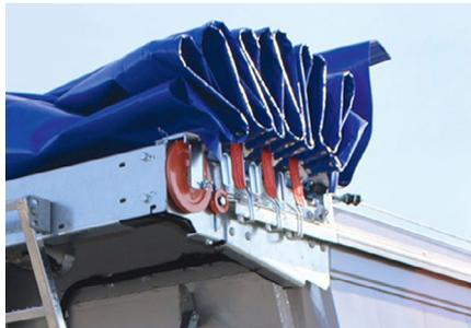
Das **Schiebeverdeck\*** ermöglicht zeitsparendes Öffnen und Schließen. Wahlweise in manueller oder elektrischer Ausführung, bedienbar per Fernbedienung.
