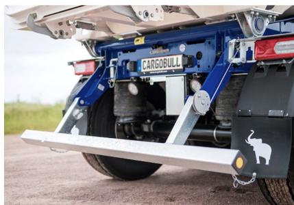
Der **klappbare Unterfahrtschutz** bietet hohe Bodenfreiheit und ist manuell bedienbar, optional erhältlich mit Federmechanik für einfaches Handling oder in pneumatischer Ausführung für erhöhte Sicherheit und Zeitersparnis.
