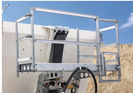
Die **Arbeitsbühne** dient der Bedienung der Rollplane und ist mit rutschhemmendem Boden, Mulden-Einstiegschilfe und Parkposition für den Hydraulikschlauch ausgestattet.
