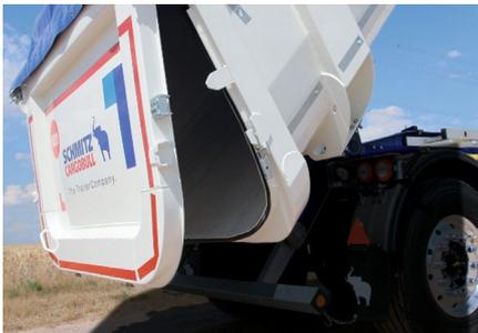
Die aufliegende **Pendelklappe** ist für Teilentladungen geeignet und optional mit Schieber erhältlich. Pendelklappen mit Schüttele, Kombitüren oder hydraulische Rückwandklappen erweitern das Angebot.
