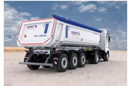
Die **Rollplane** dient als einfache und kostengünstige Muldenabdeckung gegen Nässe und Verwehungen und reduziert den Luftwiderstand. Das optionale **Schieberverdeck** ermöglicht zeitsparendes Öffnen und Schließen per Fernbedienung.
