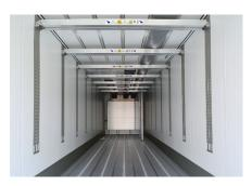
Zuverlässige Ladungssicherung: Der S.KOe COOL bietet zahlreiche Optionen angepasst an Ihre Transportbedürfnisse. Ein intelligentes System aus Ladungssicherungsschienen und Zurrösen sorgt für sicheres und einfaches Be- und Entladen.
