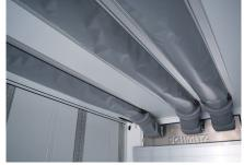
Effiziente Luftführung: Durch drei Luftkanäle mit anfahrresistenter Hutze wird die temperierte Luft mit geringem Energieaufwand gleichmäßig im Aufbau verteilt.
