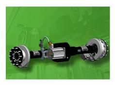
Die e-Achse lädt die Hochvoltbatterie während der Fahrt generatorisch und rekuperativ nach, wodurch die Batterielaufzeit verlängert und die Verfügbarkeit der vollelektrischen Kältemaschine erhöht wird.
