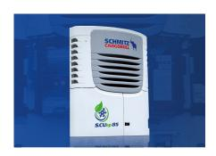
Elektrische Kältemaschine S.CU ep85 mit bis zu 15.800 Watt Kälteleistung und 10.500 Watt Heizleistung. Das Lade- und Batterie-Management stellt die konstante und effiziente Energieversorgung sicher.
