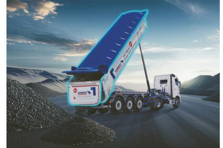
Die Rollplane dient als einfache und kostengünstige Muldenabdeckung gegen Nässe und Verwehungen und reduziert den Luftwiderstand. Das elektrische Schiebeverdeck für schnelles Öffnen und Schließen per Fernbedienung ist ebenfalls konfigurierbar.
