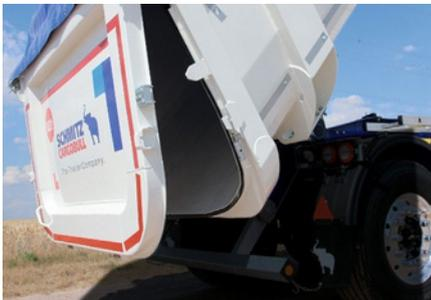
Die aufliegende **Pendelklappe** mit umlaufender Dichtung ist für Teilentladungen geeignet und optional mit Schieber erhältlich. Die Rückwand als innenliegende Pendelklappe mit Schütte oder Kombitür erweitern das Angebot.
