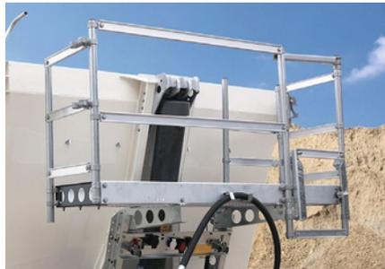
Die **Arbeitsbühne** dient der Bedienung der Rollplane und ist mit rutschhemmendem Boden, Mulden-Einstieghilfe und Parkposition für den Hydraulikschlauch ausgestattet.
