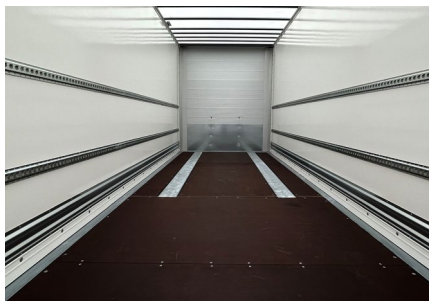
Robuster Siebdruckboden Die Bodentragfähigkeit beträgt standardmäßig 5,5 t. Optional ist das Fahrzeug auch mit einer Bodentragfähigkeit von 7,1 t oder 8,0 t verfügbar, wenn schwerere Lasten transportiert oder Flurfördergeräte mitgeführt werden.
