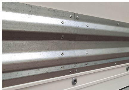
Robuste Heavy-Duty Sockelscheuerleiste schützt die Seitenwand und sorgt für schnelleres Be- und Entladen.
