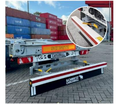
Neu konstruiert: **herausfaltbarer Unterfahrerschutz** für 45' Container ist einfacher und sicherer im Handling ohne lose Teile, die verloren gehen können.
