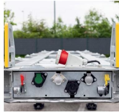
**Versenkte Anschlussleiste** am Frontbalken mit **CEE-Steckdose\*** auf dem Balken zur Versorgung von Kühlcontainern bei Genset\*.
