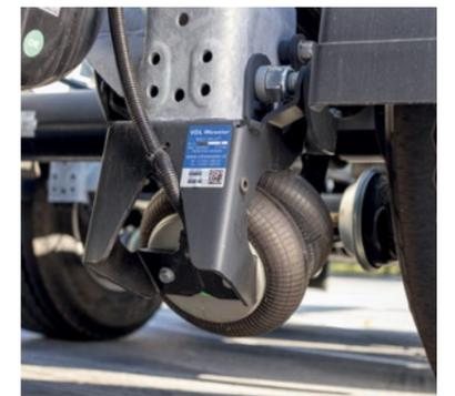
Die **Liftachse\*** als Anfahrhilfe verlängert den Radstand und verstärkt damit den Druck auf die Antriebsachse. Unbeladen reduziert sich in gelifteter Position der Reifenverschleiß.
