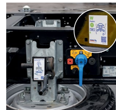
Neue Kennzeichnung an Verriegelungen und Ausschüben für die sichere Identifikation der unterschiedlichen Ladepositionen, unterstützt durch Ladeplan und Bedienvideos via QR-Code.
