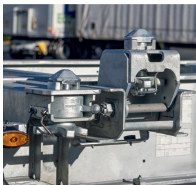
Bei 2 x 20' Beladungen übernimmt der höhenverstellbare KLAPP LOCK die Verriegelung des vorderen Containers.
