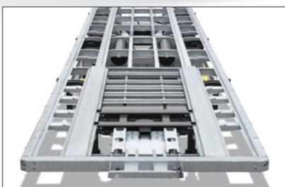
**Walzprofiliertes MODULOS-Chassis:** Korrosionsbeständig und reparaturfreundlich dank der gebolzten und feuerverzinkten Technologie.
