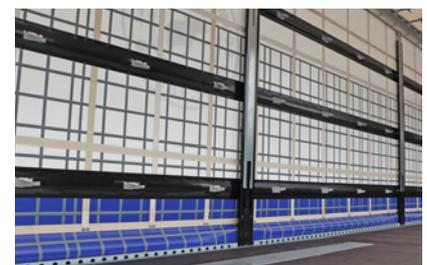
**POWER CURTAIN\*:** Aufbau ohne Aufsatzlatten für verkürzte Be- und Entladezeiten und mehr Arbeitssicherheit.
