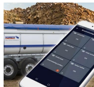
**Bremsbelagverschleißanzeige+:** Mit Hilfe der neu entwickelten BBVA+ kann die Radposition des verschlissenen Bremsbelages ermittelt werden.
