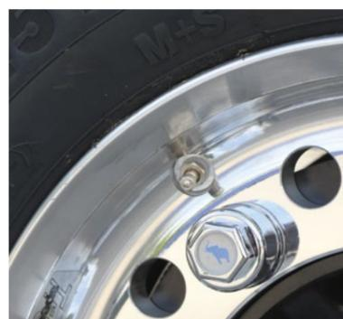
**Reifendruck-Kontrollsystem:** Vermindert Verschleiß der Reifen, senkt die Kraftstoffkosten und reduziert die Pannenhäufigkeit.
