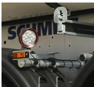
**LED Lichtpaket:** LED-Heckleuchten und vier Rückfahrcheinwerfer am Heck und seitlich über dem Fahrwerk.
