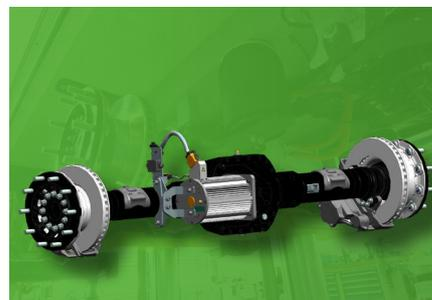
**Die e-Achse\*** lädt die Hochvoltbatterie während der Fahrt generatorisch und rekuperativ nach, wodurch die Batterielaufzeit verlängert und die Verfügbarkeit der vollelektrischen Kältemaschine erhöht wird.
