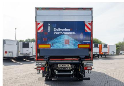
**Ladebordwand** als Heckabschluss. Standard ist eine zweiflügelige Hecktür mit vorgeklappter oder unterfahrbarer Ladebordwand.
