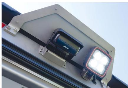
**Rückfahrkamera\*** und **LED-Arbeitscheinwerfer\*** sorgen beim Zurücksetzen, Andocken an Rampen und Rangieren für zusätzliche Sicherheit und vermeiden Schäden.
