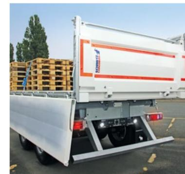
**Starrer Unterfahrerschutz.** Optional in klappbarer Ausführung für das sichere Entladen über die Heckklappe direkt in den Straßentrichter.
