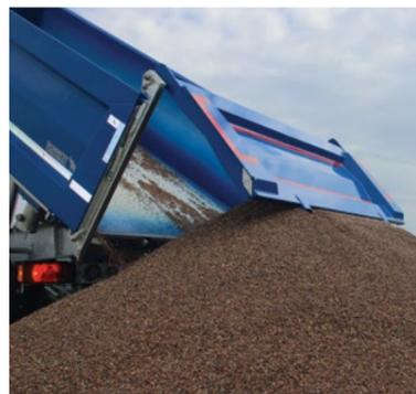
**Heck-Pendelklappe mit hochgesetztem Pendellager** zum rückseitigen Abkippen mit größerem Öffnungsquerschnitt. Robuste Eckrunga aus verzinktem Feinkornstahl.
