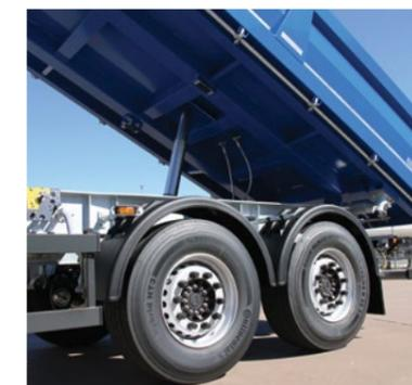
**Achslift an der 1. Achse\*** im ROTOS-Fahrwerk reduziert den Reifenverschleiß und senkt den Rollwiderstand für geringere Kraftstoffkosten.
