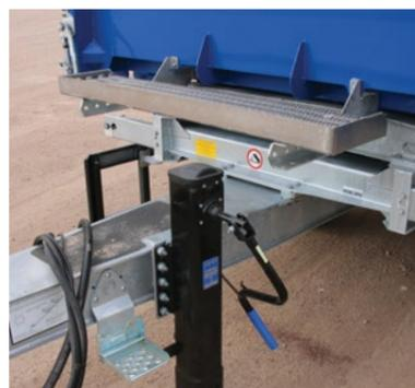
**Podest\*** an der Stirnwand für das Handling mit Rollplane. Einfacher Aufstieg über den klappbaren Tritt an der Zugdeichsel und rutschfeste Auflage auf der Deichselfläche.
