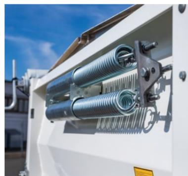
**Bordwandhebefedern\*** an der Stirnwand erleichtern das Handling der beidseitig abklappbaren Bordwände beim Be- und Entladen.
