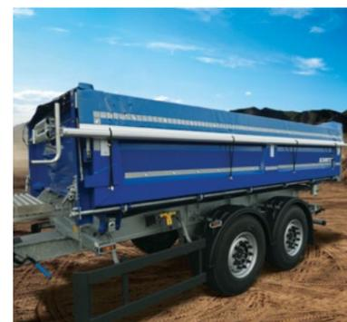
**Rollplane\*** zur Ladungssicherung: Die Muldenabdeckung schützt die Ladung vor Nässe und Schmutz, reduziert den Luftwiderstand und damit die Kraftstoffkosten.
