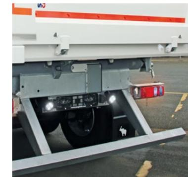
**Heckleuchten** in konventioneller oder **LED\*-Ausführung** und zwei **LED-Arbeitscheinwerfer\*** mit hoher Ausfallsicherheit und niedrigem Stromverbrauch.
