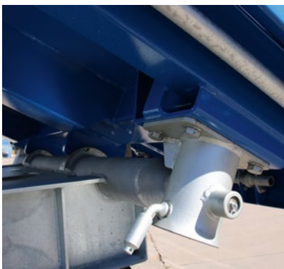
Robuste Neukonstruktion mit 60 kg Nutzlastgewinn** mit stabilen Lagern und Wellen für die Dreiseiten-Kippbrücke.
