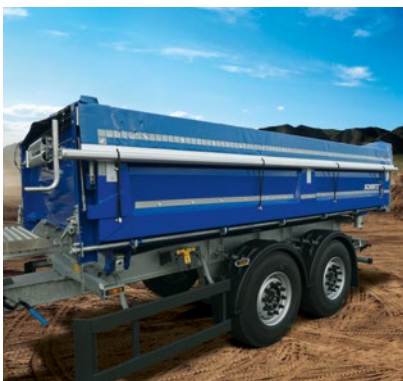
Rollplane* zur Ladungssicherung: Die Muldenabdeckung schützt die Ladung vor Nässe und Schmutz, reduziert den Luftwiderstand und damit die Kraftstoffkosten.
