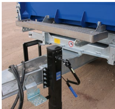
Podest* an der Stirnwand für das Handling mit Rollplane. Einfacher Aufstieg über den klappbaren Tritt an der Zugdeichsel und rutschfester Auflage auf der Deichselfläche.
