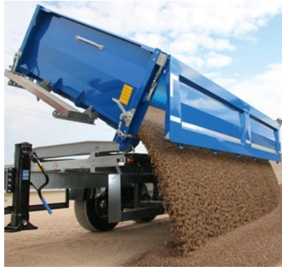
Seitliche Bordwand mit Pendelfunktion zum Abkippen von Schüttgut. Gewichtsoptimierte Bordwand aus Feinkornstahl in gesickter Ausführung.
