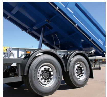
Achslift an der 1. Achse* im ROTOS-Fahrwerk reduziert den Reifenverschleiß und senkt den Rollwiderstand für geringere Kraftstoffkosten.
