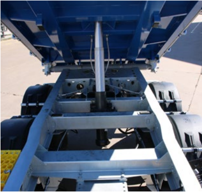
Feuerverzinktes Chassis in Schweißkonstruktion für einen verbesserten Korrosionsschutz.
