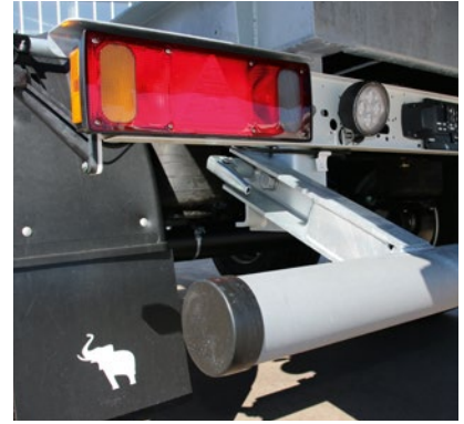
Heckleuchten in konventioneller oder LED*-Ausführung und zwei LED-Arbeits-scheinwerfer* mit hoher Ausfallsicherheit und niedrigem Stromverbrauch.
