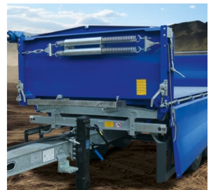
Hebefedern* an der Stirnwand erleichtern das Handling der beidseitig abklappbaren Bordwände beim Be- und Entladen.
