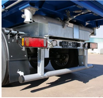
Klappbarer Unterfahrerschutz – im abgeklappten Zustand – für das sichere Entladen über die Heckklappe direkt in den Straßenfertiger.
