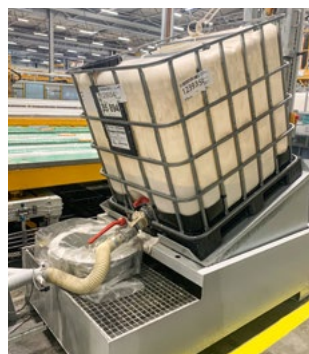
Kippvorrichtung zur Vermeidung von Kleberresten in IBC-Containern
