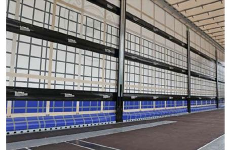
**POWER CURTAIN\* oder SPEED CURTAIN\*:** Individuelle Aufbaumöglichkeiten für schnelles, sicheres und zeitsparendes Be- und Entladen.
