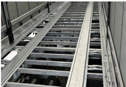
X-TOUGH Chassis mit hoher Biege- und Torsionsfestigkeit für 44 t oder mehr
