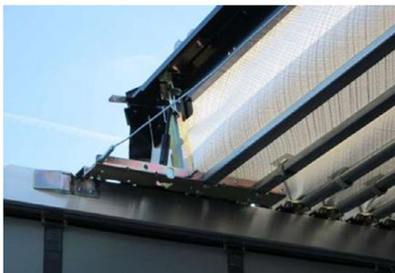
**Schmitz Cargobull Safety Roof:** Integrierte Diagonalaussteifung erhöht die Aufbaufestigkeit.
