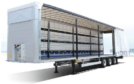
**Standardaufbau:** Die Standard-Plane des Curtainsiders ist sehr leichtgängig und lässt sich mit nur einer Hand schnell und einfach auf- und zuziehen.
