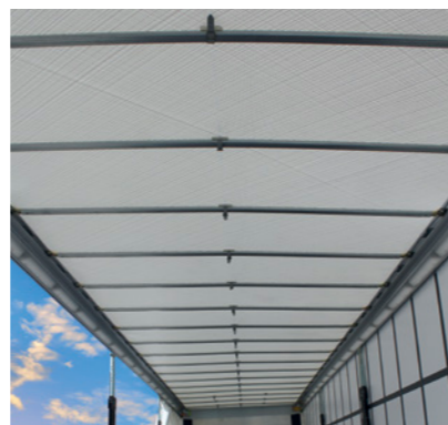
Schmitz Cargobull Safety Roof Integrierte Diagonalaussteifung erhöht die Aufbaufestigkeit.
