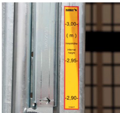
Höhenverstellung: Über Steckleisten wird die Innenhöhe in zwei 50-mm-Schritten eingestellt
