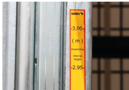
Die höhenverstellbare Aufbauvariante VARIOS sorgt für eine einfachere und flexiblere Disposition. Über Steckleisten wird die Innenhöhe in zwei 50 mm-Schritten eingestellt.
