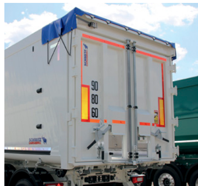
Die Kombatür mit Pendelrahmen, zwei Türflügeln und zwei Getreideschiebern.
