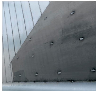
Zusätzliche Verschleißbleche im Heckbereich erhöhen die Haltbarkeit der Mulde.
