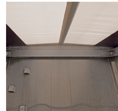
Die bogenförmige Gestaltung des Rollverdecks mit dem stabilisierenden Mittelrohr verhindert Wasseransammlungen.
