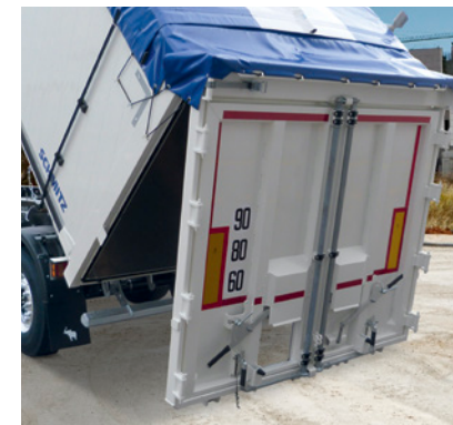
Das Entleeren mit geschlossener Plane über die Pendelfunktion der Kombatür spart Zeit beim Abladen.
