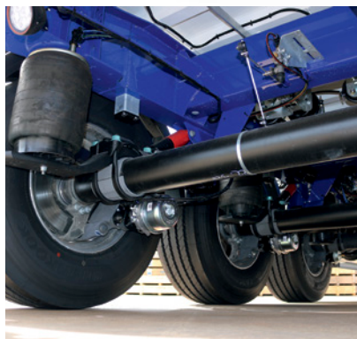
Gewichtsoptimiertes ROTOS-Fahrwerk mit niedrigerer Bauhöhe, Scheibenbremse mit 430 mm Durchmesser und Luftfederung.
