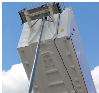
Teilversenkter Chassis-Halsbereich in der Bodengruppe der Mulde für eine niedrigere Muldenladehöhe und eine geringere Gesamthöhe.
