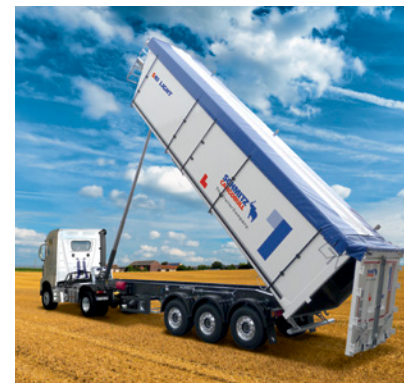
Bogenförmiges Rollverdeck für ein einfacheres Handling. Das Schließen erfolgt vom Boden aus mit dem langen Mittelspanngurt.
