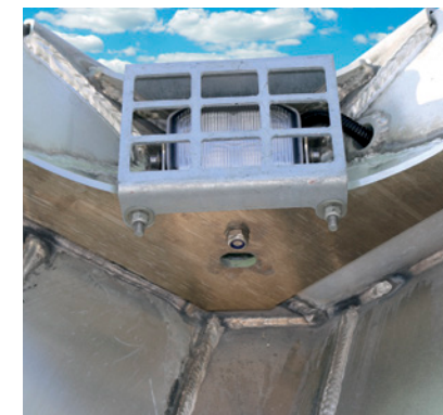
Innenraumbeleuchtung für Aluminium-Volumen-Mulden ermöglicht die Reinigung oder das Handling mit palettierte Fracht auch bei geschlossenem Verdeck.
