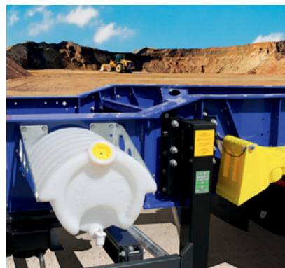
Die Kröpfung im Halsbereich des Fahrgestells (Stepframe) ermöglicht eine reduzierte Ladehöhe.
