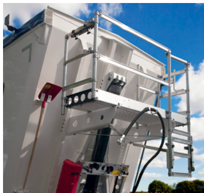
Die höhenverstellbare Arbeitsbühne mit rutschhemmendem Boden, Mulden-Einstiegshilfe und Parkposition für den Hydraulikschlauch.
