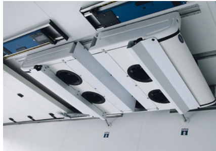
Decken-Zusatzverdampfer* für MultiTemp-Ausführungen und Anhänger in Durchladezügen.
