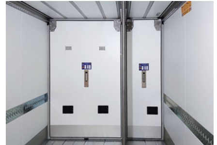
Verschiebbare Trennwand aus dampfdiffusionsdichtem FERROPLAST®: Schnelle, variable MultiTemp-Aufteilung; wahlweise für 1/3- und 2/3-Teilung oder als durchgehende Wand lieferbar.
