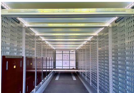
Serienmäßiges Doppelstocksystem (2 t pro Reihe) für flexible und sichere Ladungssicherung: bis zu 67 Paletten-Stellplätze.
