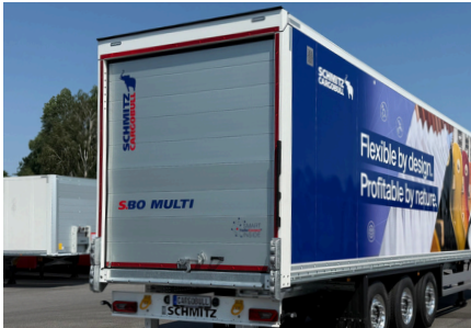
Schmitz Cargobull Rolltor* für effizientes Be- und Entladen: Das leichteste Rolltor am Markt mit XL-Zertifikat nach EN 12642 (Nutzlast bis 27 t).
