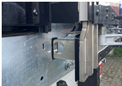
Das TAPA** TSR-1 Sicherheitspaket* sorgt für mehr Sicherheit beim Transport hochwertiger Güter. Elektronisches Türverschlusssystem, akustisches Alarmsystem und Türkontaktsensoren schützen zuverlässig vor unautorisierten Hecktüröffnungen.
