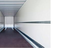
Aufgesetzte Ladungssicherungsschienen für waagerechte Sicherungsbalken und Spanngurte.
