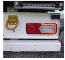
Kombinierter Verkehr: Ferry Lashings\* für Short-Sea-Verkehre. Für mehr Sicherheit - Unterfahrschutz nach der ECE Regelung 58.03.
