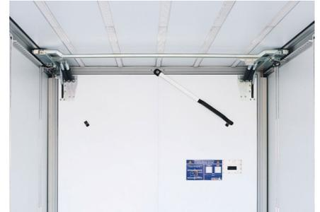
**MultiTemp-Transporte mit schwenkbarer Trennwand** aus dampfdiffusionsdichtem FERROPLAST® für flexible Disposition und höhere Auslastung.
