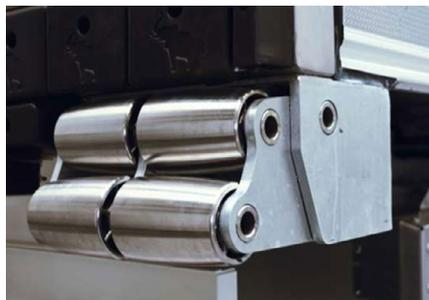
**Dynamischer Heckrammschutz (Dynamic Ramp Protection)** mit kompressiblen Rollrammpuffern, die den Anstoß an der Rampe sowie die Bewegungen durch Staplerbeladung noch sanfter und kontinuierlicher abdämpfen.
