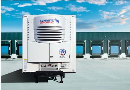
**Zuverlässige Transportkältemaschine S.CU**
