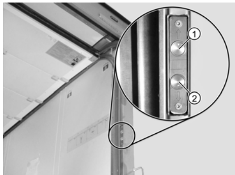
Prekidač rolo vrata na stražnjem portalu*
