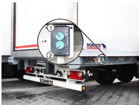
Prekidač rolo vrata ispod nadogradnje
