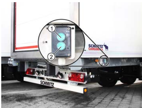
A gördülő ajtó kapcsolója a felépítmény alatt
