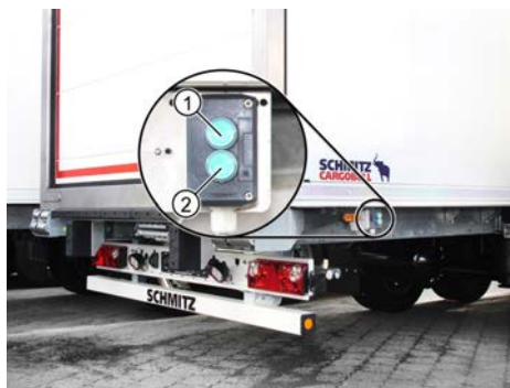
Schakelaar roldeur onder de opbouw
