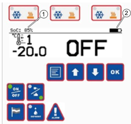
Figura 21: Stato di carica della batteria ad alta tensione S.KOe COOL
