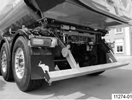
شكل 31: حاجز الحماية السفلي الذي يعمل بالهواء المضغوط كهربائياً (في وضع القيادة)
