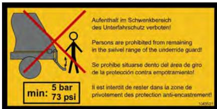
شكل 32: اللافتة التحذيرية "حاجز حماية سفلي يعمل بالهواء المضغوط"
