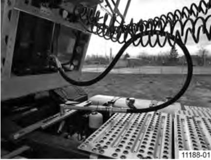
شكل 36: مثال: التوصيل الهيدروليكي بالقاطرة عند استخدام الذراع المتارجح 11188-01
