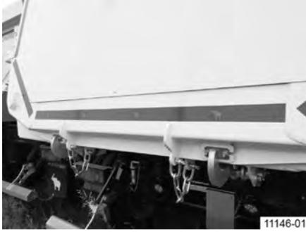
شكل 88: تجهيزة التفريغ المتساوي للحمولة
