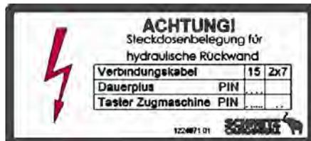
شكل 250: اللافتة التحذيرية "التوصيل بالقطب الموجب الدائم وزر الجدار الخلفي الهيدروليكي"
