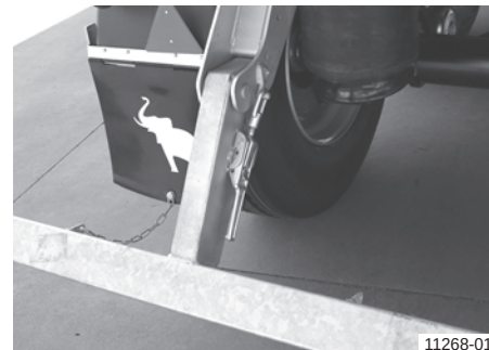
Фиксиране с фиксиращ механизъм с коленчат лост
