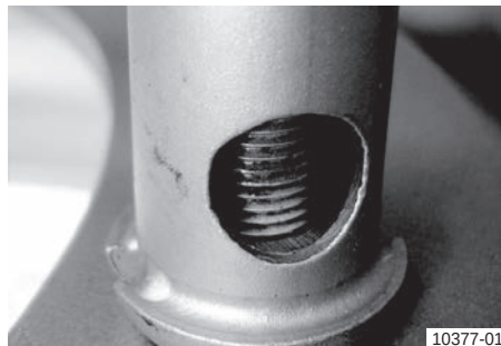
4 Задържаща скоба (отвинтена тръбна гайка); изглед отгоре
