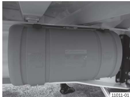
Транспортна кутия за пожарогасители на рамата на ходовата част (положение за движение)
