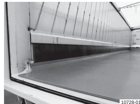
Вариант 1: Облицовка на коша на самосвала, ок. 300 mm покритие на страничната и челната стена
