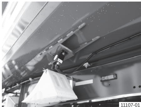
Ролков вибратор със сгъстен въздух при стоманен кош на самосвала
