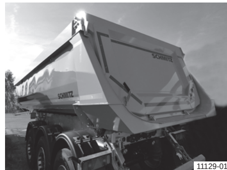
Стоманен кош на самосвала с падащ борд (наклонен), насипен товар
