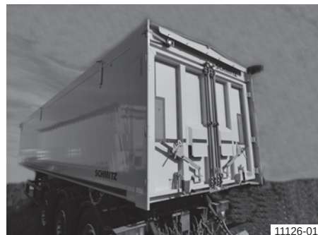
Кош на самосвала от лят алуминий с двукрила врата
