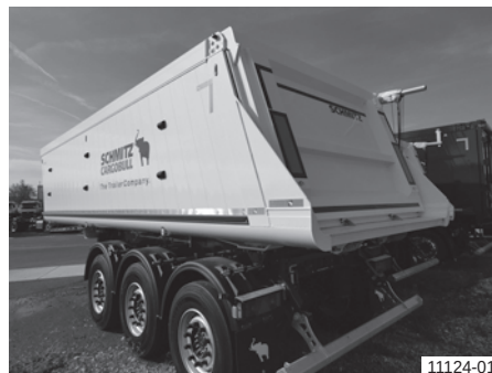
Кош на самосвала от лят алуминий с падащ борд (наклонен), насипни товари
