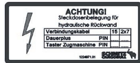
Предупредителна табелка „Постоянен плюс и бутон на хидравличния капак на задната стена“
