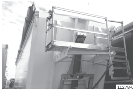
Работна платформа (монтаж към челната стена)
