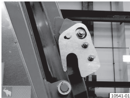
Странични заключващи куки на задната стена: отключени
