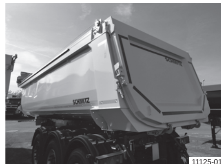
Стоманен кош на самосвала с падащ борд (наклонен), легнал
