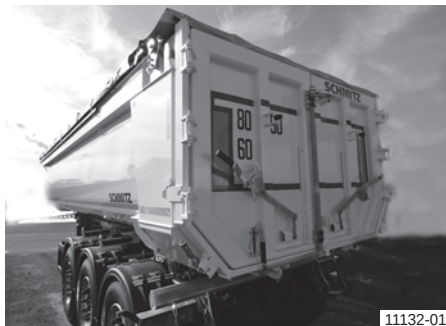
Стоманен кош на самосвала с двукрила комбинирана врата без портална напречна шпригла
