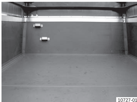
Вариант 2: Облицовка на коша на самосвала, ок. 900 mm покритие на страничната и челната стена
