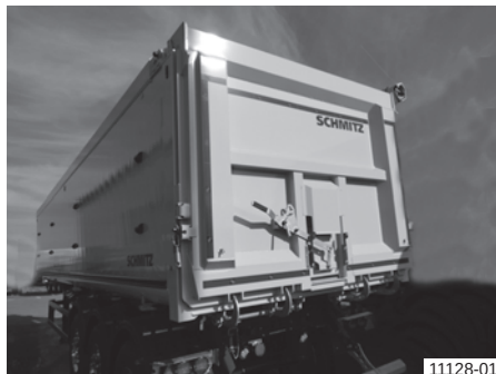
Кош на самосвала от лят алуминий с падащ борд (вертикален), легнал
