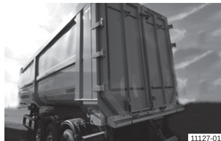
Стоманен кош на самосвала с двукрила врата
