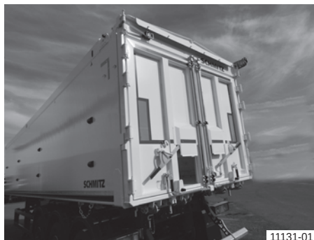
Кош на самосвала от лят алуминий с двукрила комбинирана врата с портална напречна шпригла
