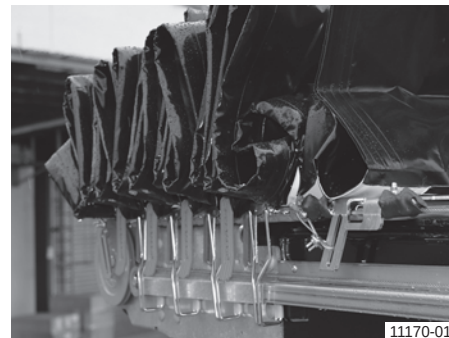
Странични куки под направляващата релса; изобразяване при отворен плъзгащ се покрив
