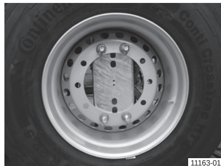
Резервно колело в държача, представяне без предпазен капак
