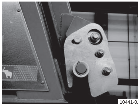
Странични заключващи куки на задната стена: заключени
