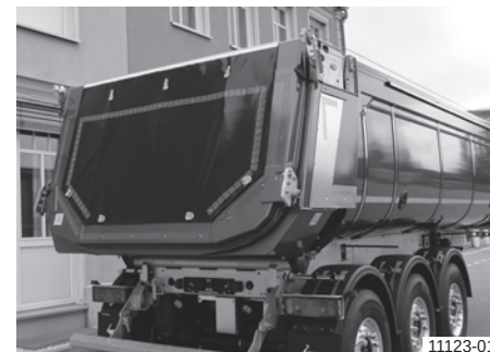
Предпазно покривало на задната стена, развито
