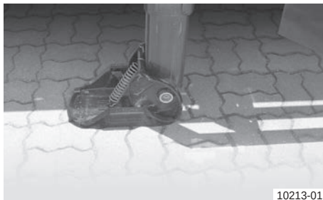
Компенсиращ крак с компенсиране на дължината
