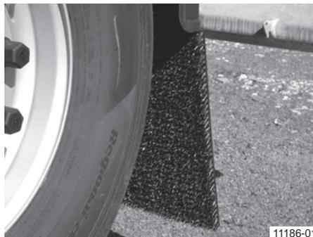
**Schmutzfänger mit Spritzschutzvorrichtung**
