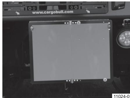
Gefahrgut-Warntafel, aufgeklappt und gesichert
