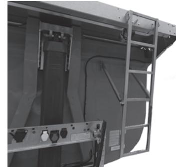
**Aufstiegsleiter an der Stirnwand\* (Fahrstellung)**
