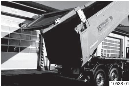
Kippen mit vollständig geöffneter Rückwand
