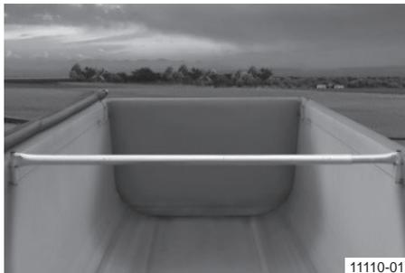
**Gerader Querspiegel (in Fahrstellung)**
