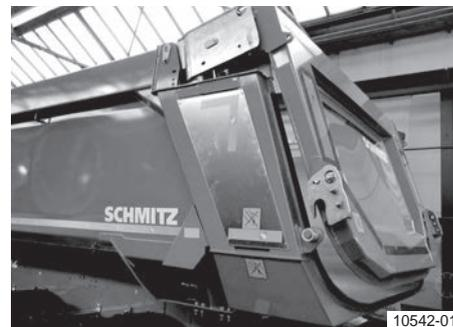
Die Rückwand ist aus den seitlichen Bolzen herausgehoben und leicht geöffnet.
