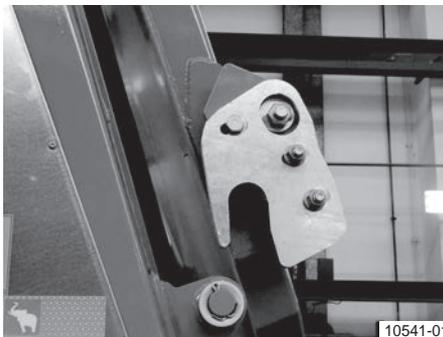
**Seitliche Verriegelungshaken der Rückwand: entriegelt**
