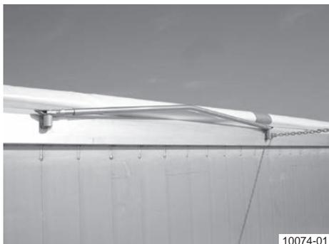
Querspiegel in Parkstellung (Darstellung dachförmiger Querspiegel)
