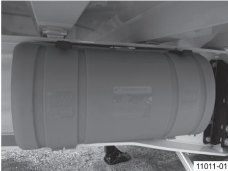
**Feuerlöscher-Transportbox am Fahrgestellrahmen (Fahrstellung)**
