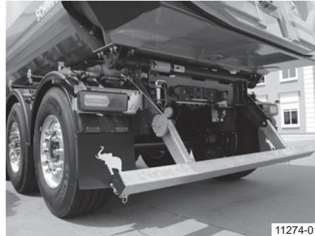
**Elektropneumatischer Unterfahrschutz (in Fahrstellung)**
