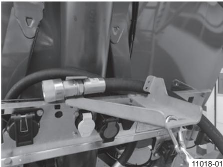
**Halter Hydraulikschlauch an der Konsole Licht/Luft**
