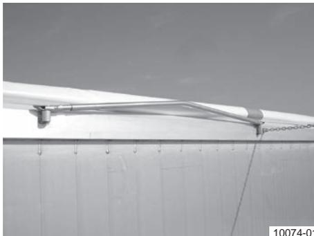
**Cercha transversal en posición de estacionamiento (representación de la cercha transversal en forma de tejado)**
