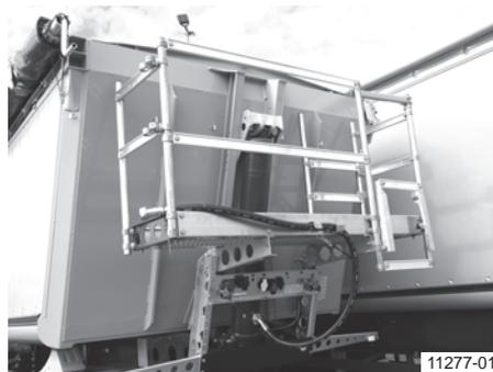
Plataforma de trabajo (montaje en el chasis)
