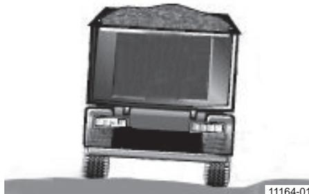
**Semirremolque volquete con inclinación lateral no permitida**
