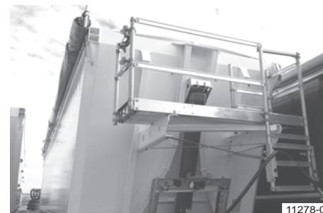
Plataforma de trabajo (montaje en la pared frontal)
