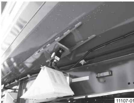
Vibrador de rodillos de aire comprimido
