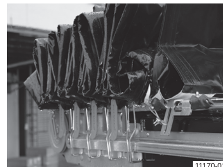
Bočne kuke ispod vodilice; prikaz pri otvorenom pomičnom krovu
