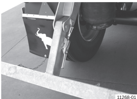
Osiguranje zatezačem s koljenastom ručicom
