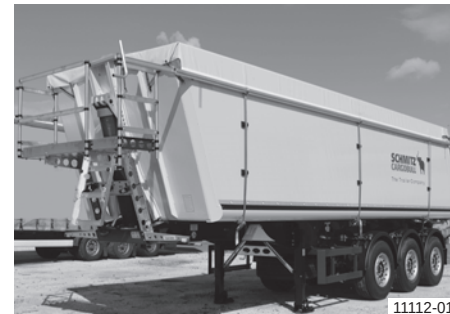
Namatajuća cerada, osigurana zateznim remenjem
