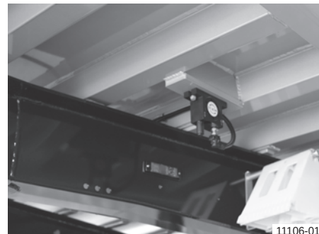
Pneumatski vibrator s valjcima na alumijskom sandučastom koritu
