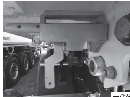
Blokada automatsko-mehaničkog zapornog mehanizma s kukama, deblokirana
