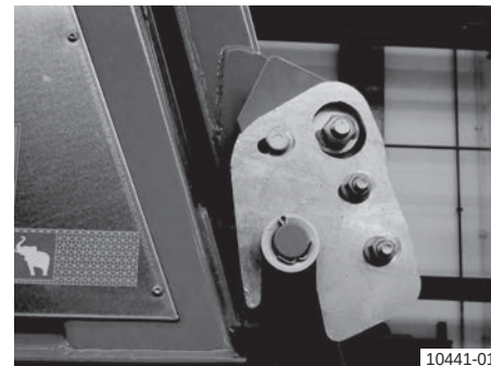
Bočna zaporna kuka stražnje stranice: blokirana
