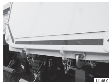
Mehanizam za dozirano razastiranje materijala
