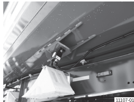
Pneumatski vibrator s valjcima na čeličnom oblom koritu
