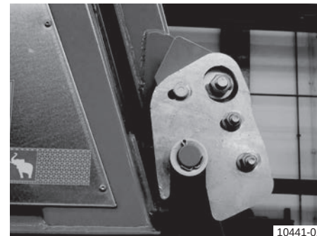
Bočna zaporna kuka stražnje stranice: blokirana
