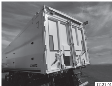
Aluminijsko sandučasto korito s dvokrilnim kombiniranim vratima s okvirom za ceradu iznad vrata
