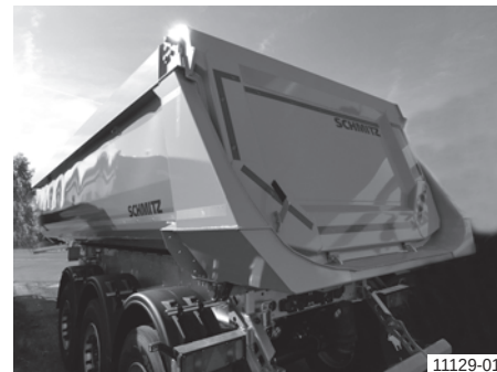
Tērauda apaļā kravas kaste ar atvāžamo vāku (slīpi), tekne
