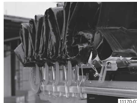
Sānu āķi zem vadīklas; attēlojuma ar atvērtu bīdāmo jumtu
