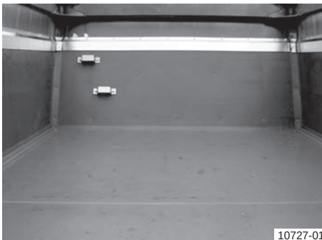
2. variants: Kravas kastes oderējums, apm. 900 mm sānu un priekšējās sienas pārsegs
