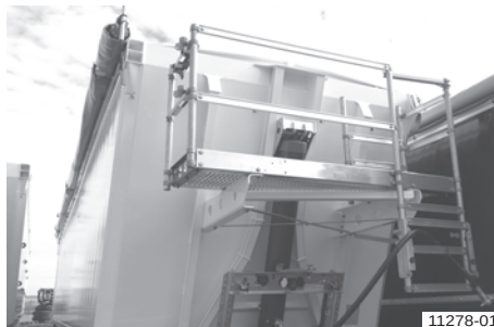
Darba platforma (montāža pie priekšējās sienas)
