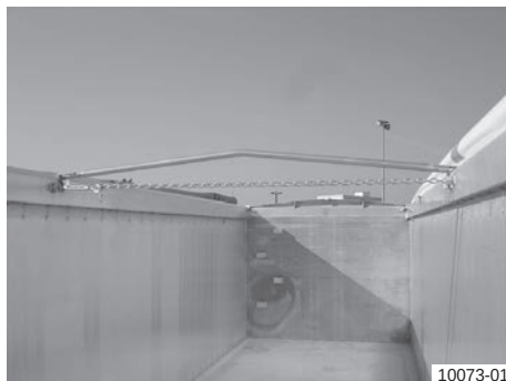
Jumta formas paralēlais tenta loks (braukšanas stāvoklī)
