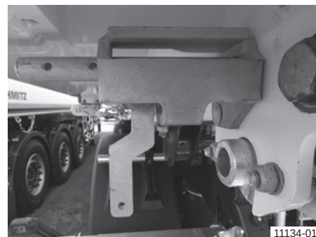
Automātiski mehāniskā āķa fiksatora bloķētājs, aktivizēts
