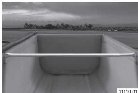
Taisns paralēlais tenta loks (braukšanas stāvoklī)
