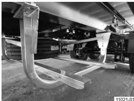
Obr. 118: Držiak náhradného kolesa v košovom vyhotovení
