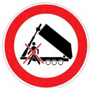
Obr. 242: Výstražný štítok „Nezdržiať sa pod vyklopenou korbou“ Č. dielu: KON001-0036
