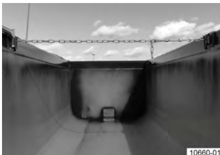
Obr. 70: Nakladanie nie je dovolené! Napínacia reťaz je príliš silno napnutá.
