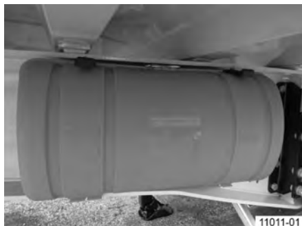
Obr. 143: Prepravný box na hasiaci prístroj na ráme podvozku (pozícia pre jazdu)
