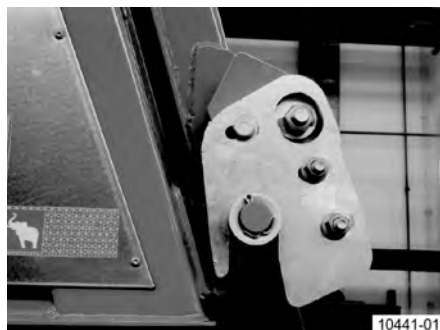
Obr. 56: Bočné zaistovacie háky zadnej steny: zaistené
