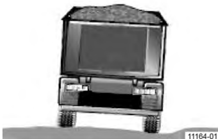
Obr. 189: Sklápací sedlový náves s neprípustným bočným sklonom
