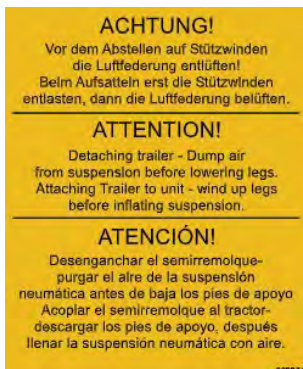
Obr. 168: Výstražný štítok „Podperné nohy“
