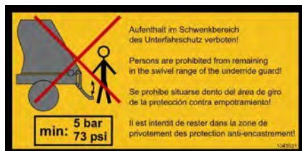
Obr. 32: Výstražný štítok „Pneumatická ochrana proti podbehnútiu“
