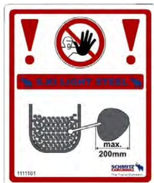
Obr. 252: Výstražný štítok „Maximálna frakcia sypkého materiálu S.KI light“ Č. dielu: 1111161
