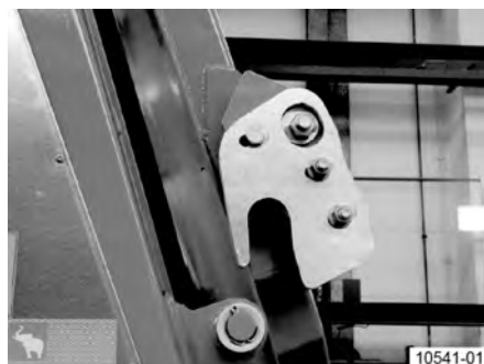
Obr. 57: Bočné zaistovacie háky zadnej steny: odistené
