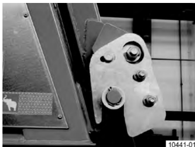
Obr. 196: Bočné zaistovacie háky zadnej steny: zaistené
