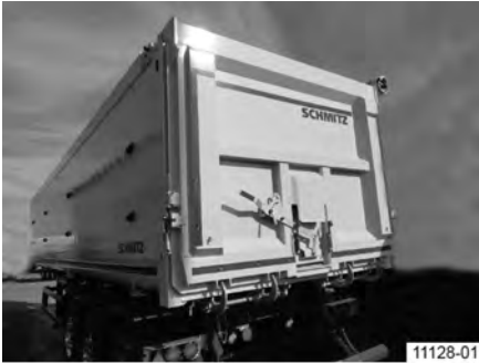
Obr. 41: Hliníková skriňová korba s výkyvnou klapkou (zvislá), uložená
