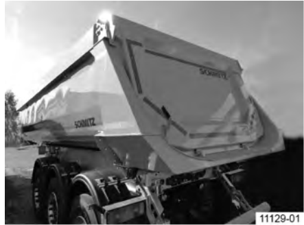
Obr. 44: Oceľová oblá korba s výkyvnou klapkou (naklonená), násypka
