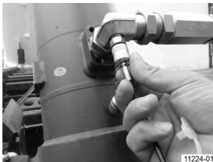
Obr. 40: Montáž vypúšťacej hadice na prípojku na núdzové vypustenie*
