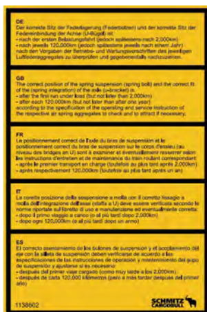
Obr. 256: Výstražný štítok „Uloženie pružín“ Č. dielu: 1138602 (pre Západnú Európu) alebo 1138604 (pre Východnú Európu)
