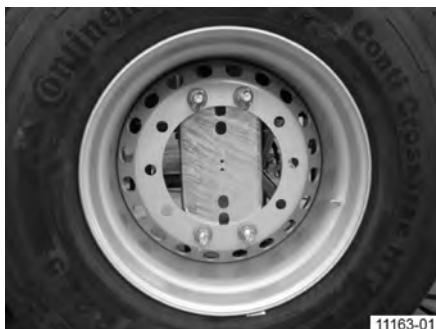
Obr. 126: Náhradné koleso v držiaku, zobrazené bez ochranného krytu
