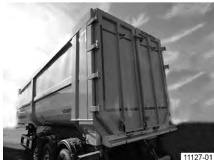
Obr. 46: Ocelová oblá korba s dvojkřídlovými dveřmi
