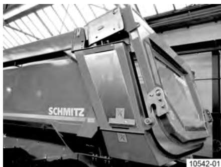
Obr. 193: Zadná stena je vyzdvihnutá z bočných čapov a ľahko otvorená.
