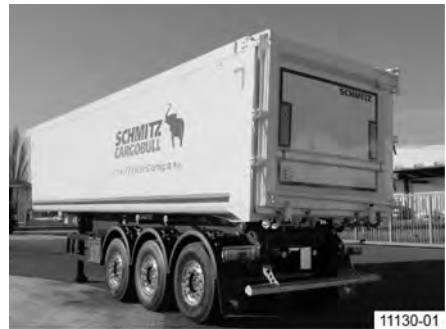
Obr. 49: Hliníková skriňová korba s jednokridlovými kombinovanými dverami
