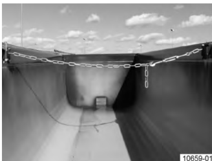
Obr. 69: Nakladanie nie je dovolené! Napínacia reťaz je nedostatočne napnutá.
