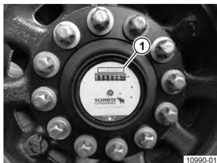
Obr. 34: Odometer na náboji kola
