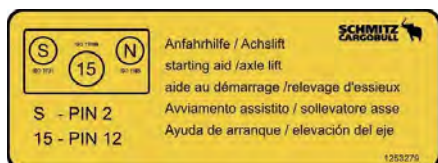
Obr. 249: Informačný štítok „Obsadenie ISO PIN-ov pre pomoc pri rozjazde/zariadenie na zdvíhanie náprav“ Č. dielu: 1253275
