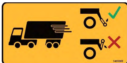
Obr. 245: Výstražný štítok „Pozícia ochrany proti podbehnútiu nohy“ Č. dielu: 1433385
