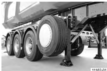
Obr. 125: Držiak náhradného kolesa na boku na podvozku
