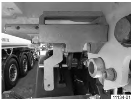
Obr. 52: Blokovanie automatického mechanického hákového zaistenia, povolené
