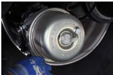
Obr. 19: Odobratie uvoľňovacej tyčky zariadenia núdzového uvoľnenia
