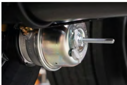
Obr. 21: Zariadenie núdzového uvoľnenia pružinového zásobníka je aktivované
