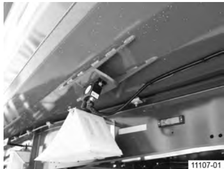
Obr. 85: Valčekový vibrátor na stlačený vzduch – oceľová oblá korba
