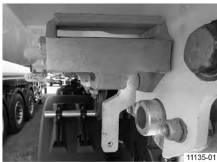
Obr. 53: Blokovanie automatického mechanického hákového zaistenia, zablokované
