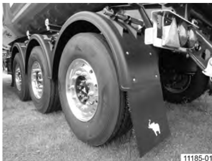
Obr. 162: Podbeh kolesa s lapačom nečistôt na zadnej náprave (s ochranou proti striekaniu)
