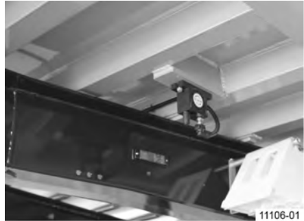
Obr. 84: Valčekový vibrátor na stlačený vzduch – hliníková skriňová korba
