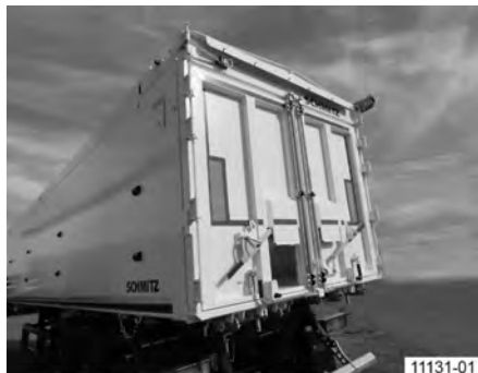
Obr. 45: Hliníková skříňová korba s dvojkřídlovými dveřmi
