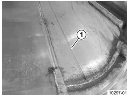
Obr. 204: Značka opotrebovania na dne hliníkovej korby
