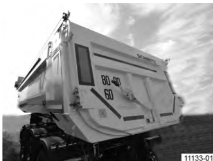
Obr. 50: Oceľová obľá korba s hydraulickou klapkou zadnej steny
