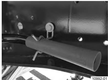
Obr. 110: Kľuka zaistená v uchytení kľuky (na ráme)
