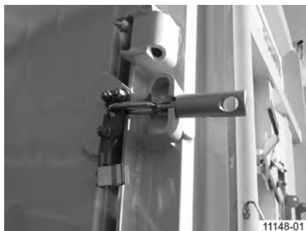
Obr. 64: Upínací uzáver zatvorený (pozícia pre jazdu)
