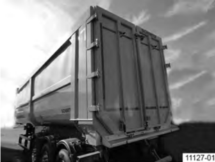
Obr. 48: Oceľová oblá korba s dvojkridlovými kombinovanými dverami bez portálovej priečnej vzpery
