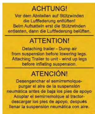
Obr. 241: Výstražný štítok „Podperné nohy“ Č. dielu: 920974
