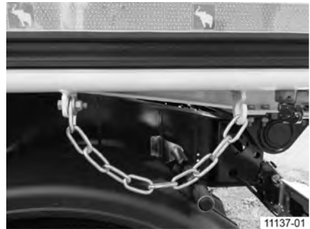
Obr. 72: Bezpečnostná reťaz v pozícii pre jazdu
