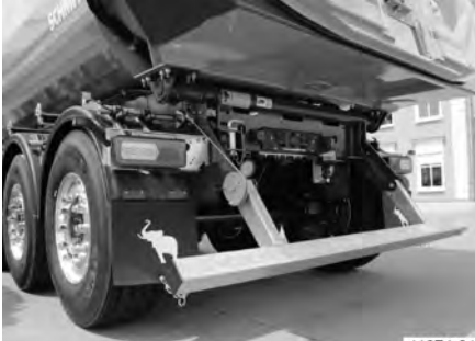
Obr. 31: Elektropneumatická ochrana proti podbehnutiu (v pozícii pre jazdu)
