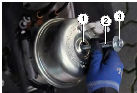
Obr. 20: Nasadenie uvoľňovacej tyčky do upevňovacieho otvoru
