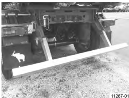
Obr. 25: Príkladné zobrazenie manuálne ovládanej ochrany proti podbehnutiu v zaistejnej pozícii pre jazdu (dolná koncová poloha, zaistená)
