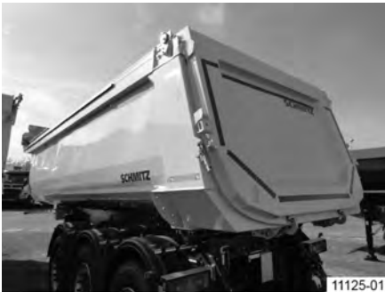
Obr. 43: Oceľová oblá korba s výkyvnou klapkou (naklonená), uložená
