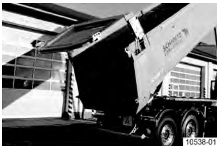
Obr. 195: Vyklápanie s úplne otvorenou zadnou stenou
