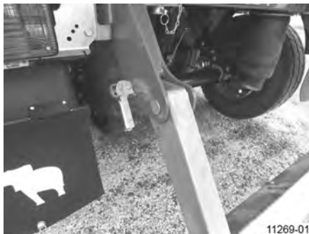
Obr. 26: Zaistenie pomocou pružinovej závery
