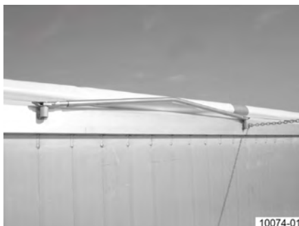
Obr. 95: Priečna vzpera v parkovacej pozícii (zobrazenie strechovitej priečnej vzpery)
