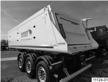
Obr. 42: Hliníková skriňová korba s výkyvnou klapkou (naklonená), násypka
