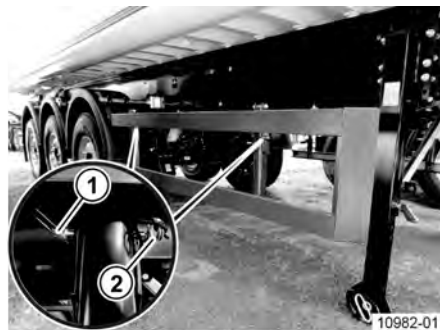
Obr. 22: Bočné ochranné zariadenie v pozícii pre jazdu (zaistené)
