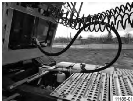
Obr. 36: Príklad: Hydraulické pripojenie k ťahaču pri použití otočného ramena
