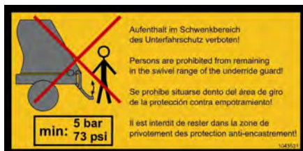
Obr. 244: Výstražný štítok „Pneumatická ochrana proti podbehnútiu“ Č. dielu: 1043531
