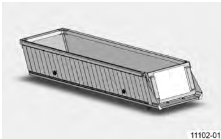
Obr. 78: Hliníková skriňová korba, tepelne izolovaná
