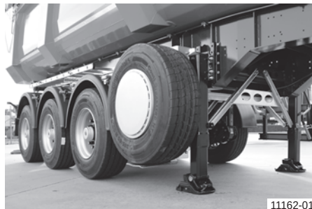
Držač rezervnog točka, bočno na voznom postolju
