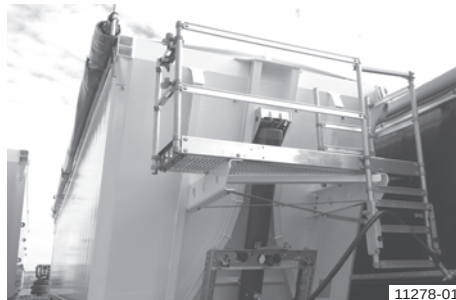
Radna platforma (montaža na čeonj stranici)
