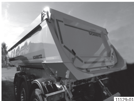
Čelična ovalna kiper nadgradnja sa zadnjom stranicom (pod nagibom), oluk za nasipanje
