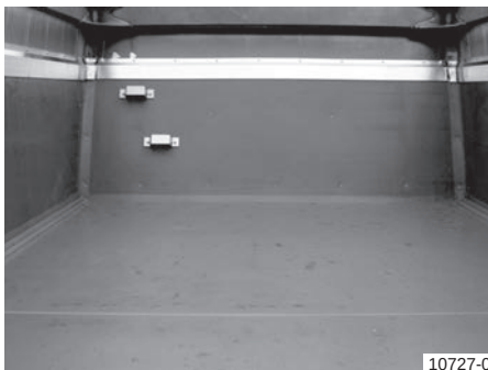
2. varijanta: Oplata sanduka, oko 900 mm pokrivača bočnih stranica i čeonj stranice
