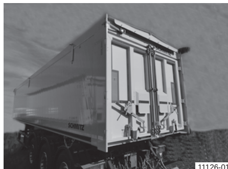
Aluminijumska četvrtasta kiper nadgradnja sa dvokrilnim vratima
