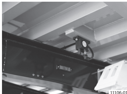
Pneumatski vibrator kod aluminijumske četvrtaste kiper nadgradnje
