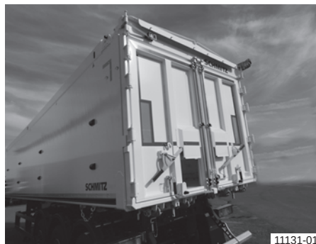
Aluminijumska četvrtasta kiper nadgradnja sa dvokrilnim kombinovanim vratima i poprečnim lukom krova
