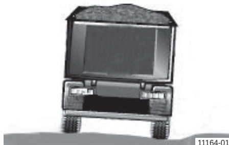
Kiper prikolica sa nedozvoljenim bočnim nagibom
