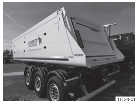
Aluminijumska četvrtasta kiper nadgradnja sa zadnjom stranicom (pod nagibom), oluk za nasipanje
