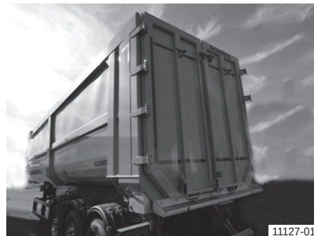
Čelična ovalna kiper nadgradnja sa dvokrilnim vratima
