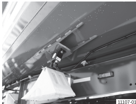
Pneumatski vibrator kod čelične ovalne kiper nadgradnje
