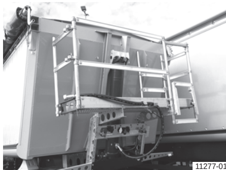
Radna platforma (motaža na voznom postolju)
