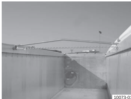
Poprečni luk u obliku krova (u položaju vožnje)
