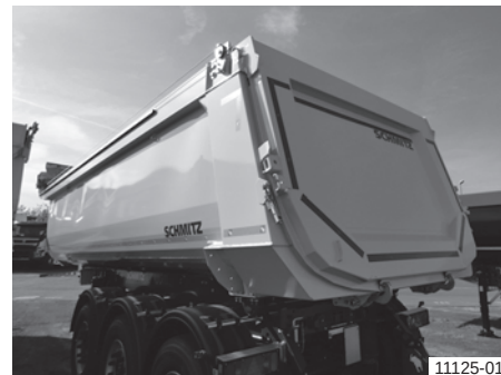
Čelična ovalna kiper nadgradnja sa zadnjom stranicom (pod nagibom), naležuća
