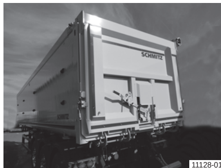
Aluminijumska četvrtasta kiper nadgradnja sa zadnjom stranicom (vodoravna), naležuća
