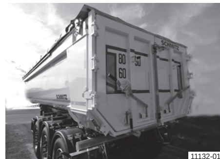
Čelična ovalna kiper nadgradnja sa dvokrilnim kombinovanim vratima bez poprečnog luka krova
