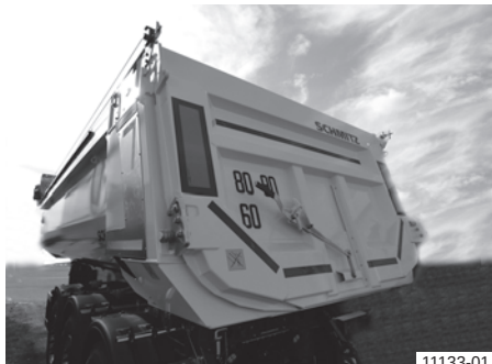
Čelična ovalna kiper nadgradnja sa hidrauličnom zadnjom stranicom
