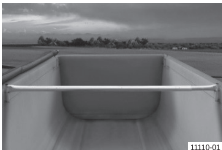
Pravi poprečni luk krova (u položaju vožnje)
