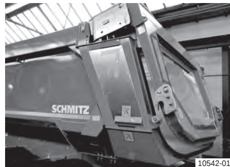
Задній борт піднято з бічних пальців і трохи відкрито.
