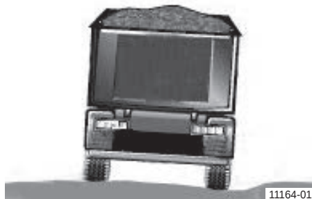
Самоскидний напівпричіп з недопустимим бічним нахилом
