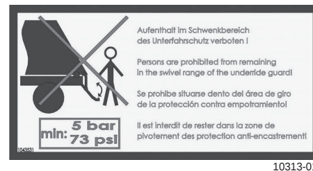
Попереджувальна табличка «Протипідкатний брус з пневматичним приводом» № деталі: 1043531
