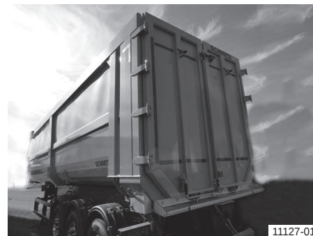
Сталева заокруглена ковшова платформа з двостулковими дверима
