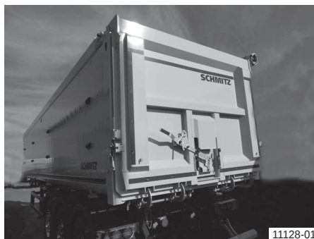
Алюмінієва коробчата ковшова платформа з хитною заслінкою (вертикальною), зовнішньою
