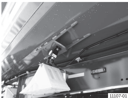
Пневматичний роликовий вібратор сталевій заокругленій ковшової платформи
