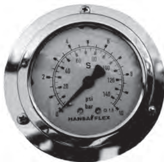
Індикатор навантаження на вісь* (покажчик тиску)
