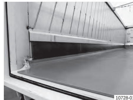
Варіант 1: Облицювання ковшової платформи, покриття бічних та переднього бортів на прибл. 300 мм
