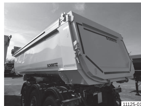
Сталева заокруглена ковшова платформа з хитною заслінкою (похилою), зовнішнім
