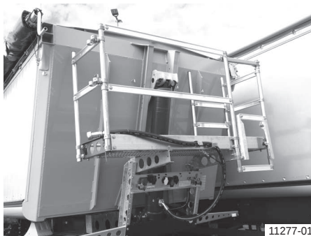
Робоча платформа (кріплення на шасі)
