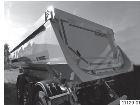
Сталева заокруглена ковшова платформа з хитною заслінкою (похилою), з жолобом
