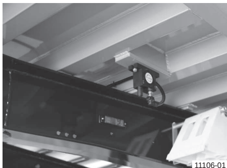
Пневматичний роликовий вібратор алюмінієвої коробчастої ковшової платформи
