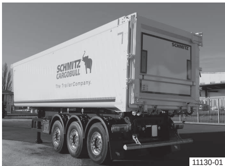
Алюмінієва коробчаста ковшова платформа з одноствулковими комбінованими дверима
