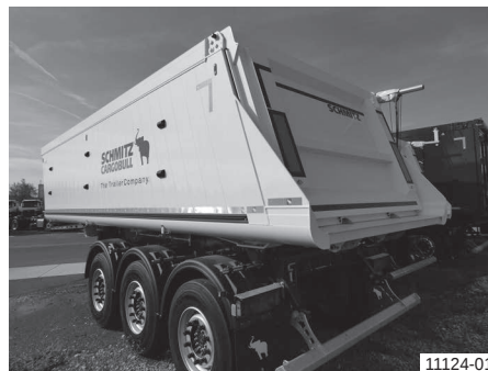
Алюмінієва коробчата ковшова платформа з хитною заслінкою (похилою), з жолобом
