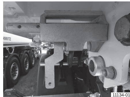
Фіксатор автоматичного механічного гакового замка, розблокований
