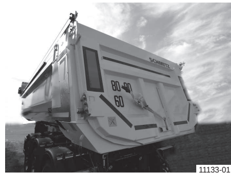
Сталева заокруглена ковшова платформа з заслінкою заднього борта з гідравлічним приводом
