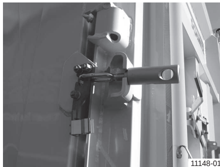
Натяжний замок закрито (положення руху)
