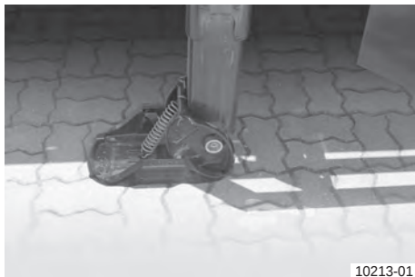
Хитна опора з компенсацією довжини
