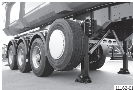
Тримач запасного колеса збоку на шасі
