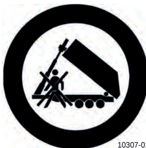
Попереджувальна табличка «Не стійте під перекинутою ковшовою платформою» № деталі: KON001-0036
