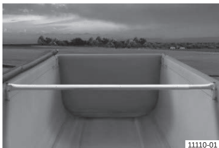
Пряма поперечна дуга тенту (у положенні руху)
