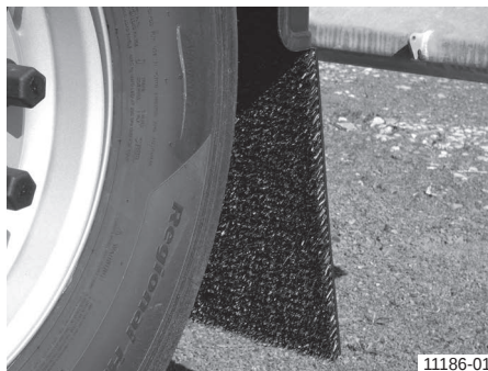
Бризковики із захисним пристроєм від бризок
