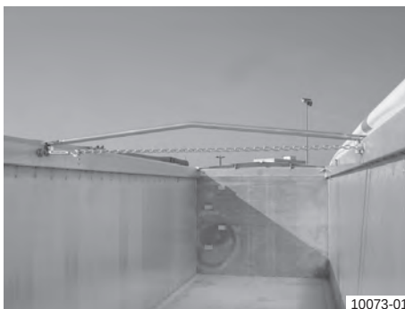
Дахоподібна поперечна дуга тенту (у положенні руху)
