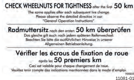
Наклейка з повідомленням «Посадка гайок кріплення коліс» № деталі: 920223
