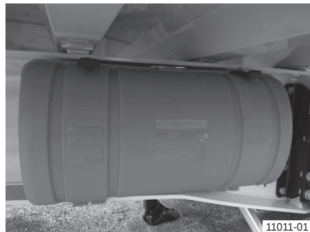
Ящик для транспортування вогнегасника на рамі шасі (положення руху)
