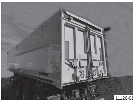
Алюмінієва коробчата ковшова платформа з двостулковими дверима
