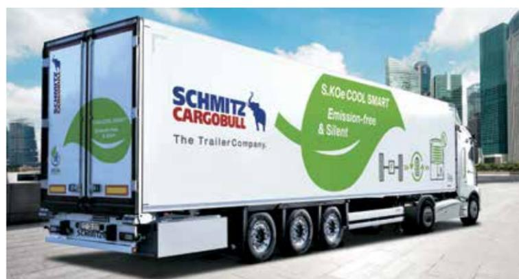
Beim S.KOe ist auch das Kühlaggregat elektrisch und bietet eine Kälteleistung von 15.800 Watt. Die Heizleistung beträgt 10.500 Watt.
