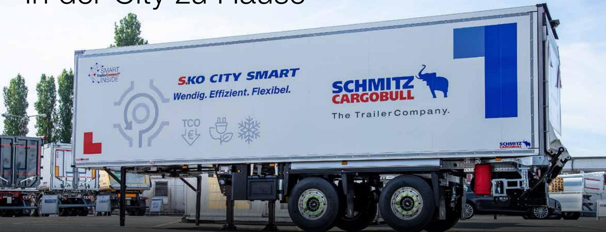
Für den Verteilerverkehr in Innenstädten bietet Schmitz Cargobull den wendigen Sattelkoffer S.KO CITY. Der Zweiachser ist zwangsgelenkt, hat das elektrisch betriebene Kühlgerät S.CU e85 an Bord und ist serienmäßig smart.
