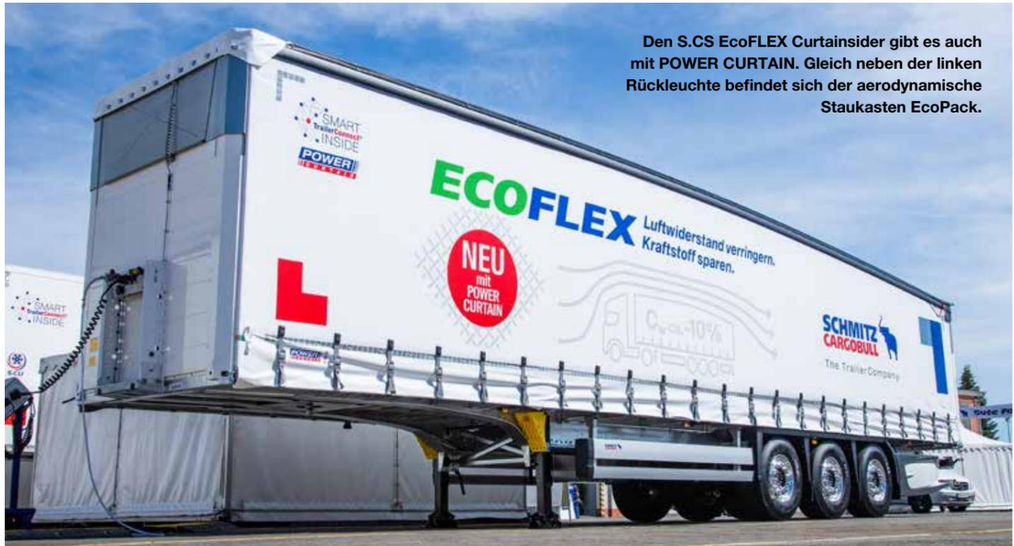
Den S.CS EcoFLEX Curtainsider gibt es auch mit POWER CURTAIN. Gleich neben der linken Rückleuchte befindet sich der aerodynamische Staukasten EcoPack.
