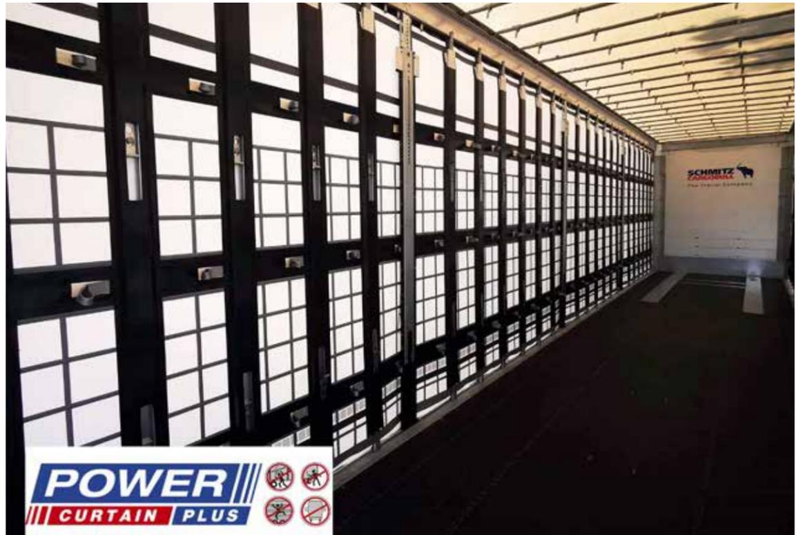
**Kombiniert mit Gurten oder einer Ladungssicherungsplane entwickeln die drei Reihen Ladungssicherungsschlaufen des S.CS MEGA DB POWER CURTAIN PLUS Blockierkräfte von bis zu 7.500 Dekanewton.**
