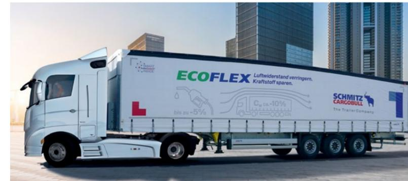
**Reducción eficiente del combustible:** La parte trasera aerodinámica reduce la resistencia mediante una superficie más pequeña y una menor formación de turbulencias, lo que permite un mayor flujo de aire detrás del vehículo.
