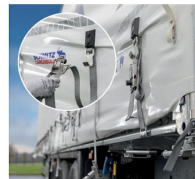
**El rápido ajuste de la lona lateral** en EcoFLEX y EcoVARIOS permite un paso sencillo de parte trasera aerodinámica a volumen de carga completo.
