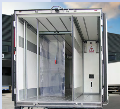
Partición longitudinal para distintas cámaras de temperatura.
