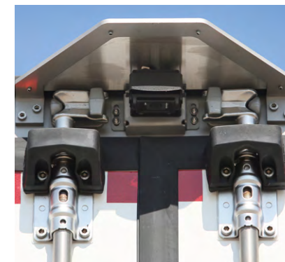
La cámara de marcha atrás sobre la puerta trasera facilita la visión de aproximación al muelle.
