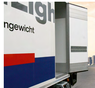
Puerta lateral: para descarga o acceso a distintas zonas de temperatura.
