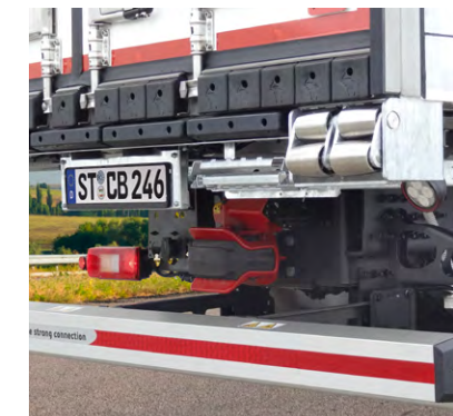
Los topes traseros de rodillos con amortiguación DRP y el listón doble de goma protegen la parte trasera al aproximarse al muelle.
