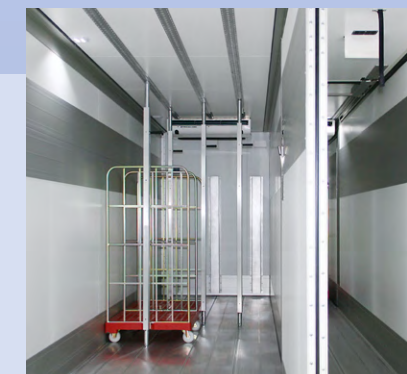
Los carriles Airline en techo y suelo facilitan la sujeción de la carga con viguetas telescópicas verticales.
