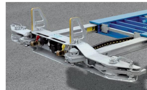
**Travesaño delantero extensible** con rodapiés. Se pueden fijar contenedores de 45' por la parte frontal de forma más rápida y segura.
