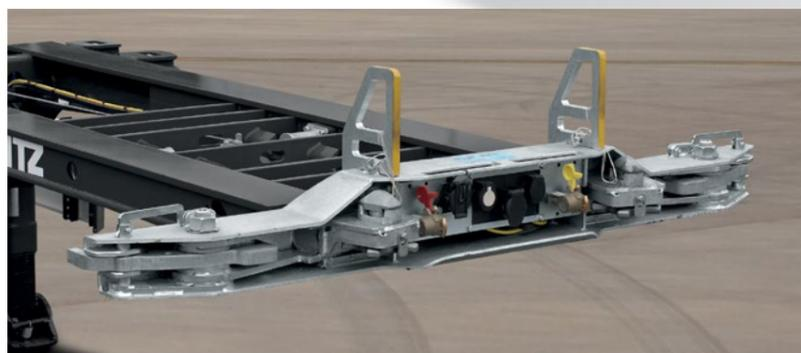
La extensión delantera con **MULTI LOCK**® para alojar contenedores de 45' EU se extrae mecánicamente de un modo seguro y rápido.
