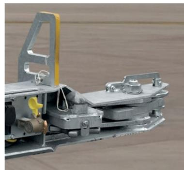
La extensión delantera con **MULTI LOCK®** para alojar contenedores de 45' se extrae mecánicamente de un modo seguro y rápido.
