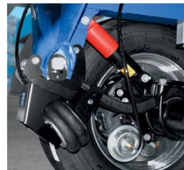
El **eje elevable\*** con ayuda de arranque aumenta la batalla y refuerza con ello las presiones sobre el eje motriz.
