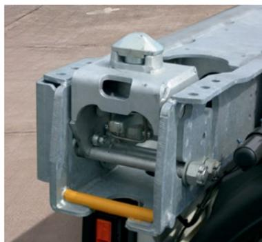
Sistema **STEP LOCKS®** en travesaño trasero diseñado para fijar contenedores de 40' con y sin túnel, así como la parte trasera de un contenedor de 20' centrado.
