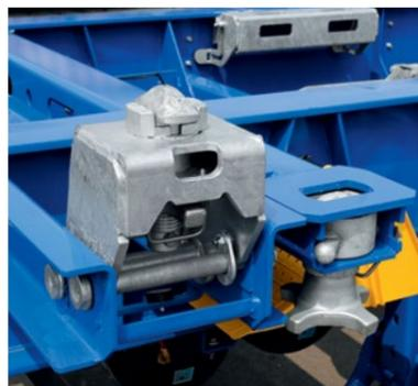
El modelo **KLAPP LOCK** giratorio permite ajustar la parte trasera de un contenedor de 20' posicionado en la parte delantera.
