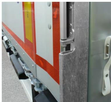
**Protección trasera:** bisagras protegidas mediante la construcción robusta del marco trasero.
