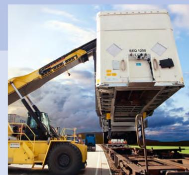
**Transporte combinado:** las pinzas homologadas permiten la carga sobre el vagón.
