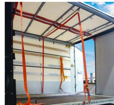
**El sistema Sliding Lashing** permite sujetar de forma rápida y segura la mercancía.
