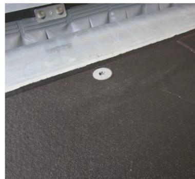
**El suelo antideslizante** con un alto coeficiente de retención de la carga, no necesita fijaciones adicionales.
