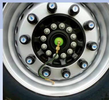
**El sistema de control y mantenimiento de la presión de los neumáticos** reduce el desgaste y el consumo de combustible.
