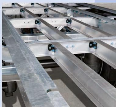
**Chasis MODULOS:** resistente a la corrosión y fácil de reparar gracias a la tecnología de embulonado y galvanizado en caliente.
