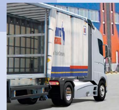
**SPEED CURTAIN:** acceso rápido y seguro a la apertura de la carrocería para carga o descarga.
