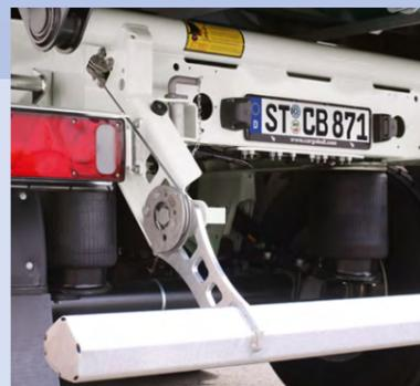
**La barra antiempotramiento abatible accionada neumáticamente**, facilita una adaptación sencilla a la máquina asfaltadora. (Opcional)
