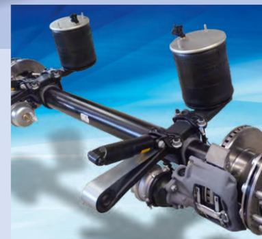
**Tren de rodaje Modelo ROTOS** con freno de disco. Fabricado con componentes de primera calidad. Suspensión neumática multi-right-height (MRH).
