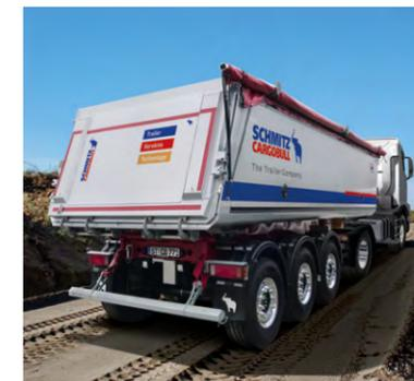
**Versión con aislamiento térmico** para el transporte de asfalto. (Opcional)
