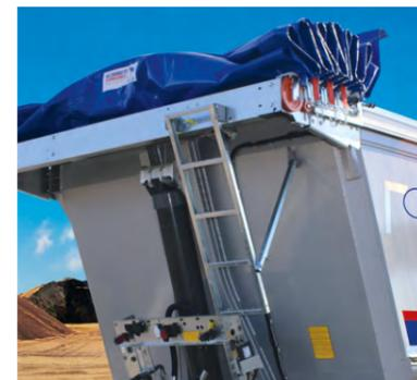
**La lona corredera** facilita la sujeción de la carga de forma segura. Disponible en versión manual o eléctrica.
