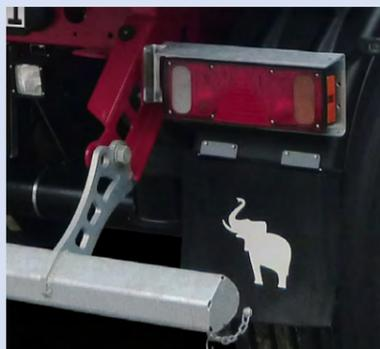
**Instalación de luz convencional** con iluminación multicámara.
