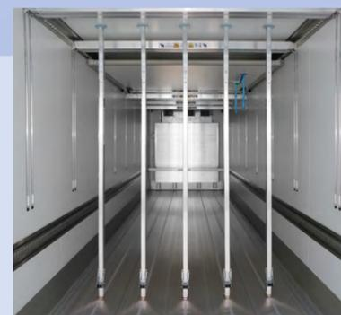
**Las viguetas telescópicas verticales** se pueden colocar de forma sencilla y rápida para sujetar la carga en el piso multifunción MF5.
