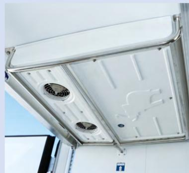
**Potente evaporador adicional de techo compacto** para el funcionamiento de dos cámaras.
