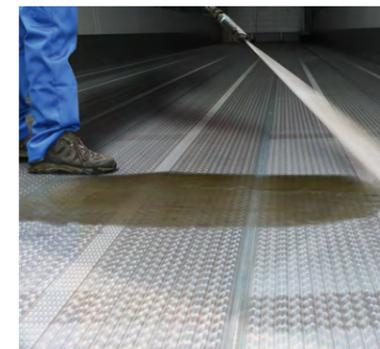
**Limpieza rápida** del suelo MF5 debido a la unión soldada y estanca con los laterales. Ahorra tiempo y cumple con los requisitos en materia de higiene.
