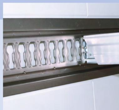
**La guía de sujeción de carga V7** permite el posicionamiento de las viguetas de carga horizontales en toda la longitud del vehículo.
