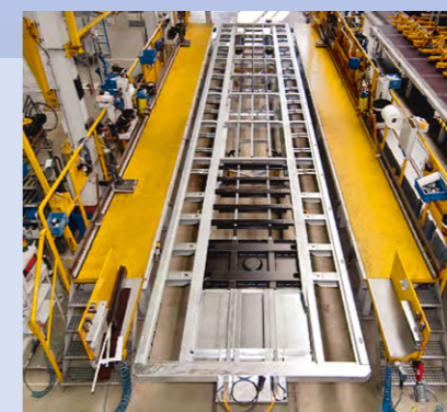
Chasis MODULOS totalmente galvanizado: 10 años de garantía contra la oxidación.
