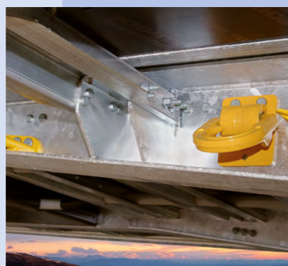
Transporte combinado: anillas tipo ferry en el larguero para el tráfico marítimo.
