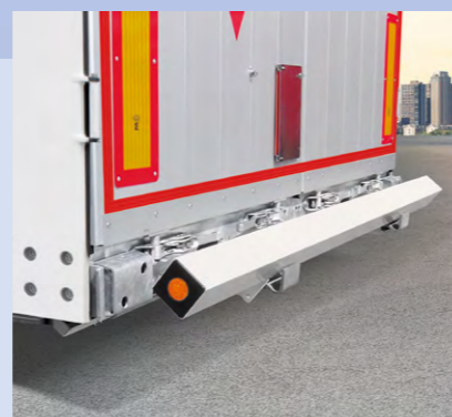
Barra antiempotramiento plegable en tráfico combinado para carga ferroviaria y transporte en ferry.
