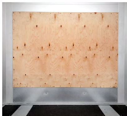
Frontal de aluminio con recubrimiento de madera y cantoneras de acero: mayor protección para la carga y el semirremolque.
