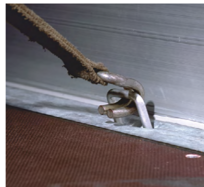
Piso multifunción antideslizante y bastidores exteriores de acero con anillas de amarre integradas para la sujeción de la carga.
