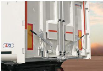
Alu-Kombi- und Doppelflügel-türen sind serienmässig mit zwei Getreideschiebern ausgestattet. Die Getreideschieber ermöglichen das dosierte Entladen feiner Schüttgüter.
