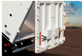
Aufliegende Pendelklappe 90° mit umlaufender Gummidichtung. Pendelfunktion der Doppelflügel-Kombitür.
