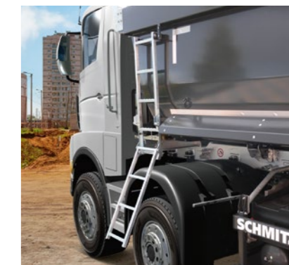
Umfangreiche Zusatzausstattungen wählbar: seitliche Aufstiegsleiter für die Ladungskontrolle.
