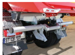
Optional lieferbar: Gekröpfter, klappbarer Unterfahrschutz für Fahrzeuge mit Anhängerkupplung
