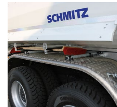
Seitliche Abweiserbleche zum Schutz beim Be- und Entladen vor herabfallendem Schüttgut. Halter für die Aufbewahrung von Besen und Schaufel.
