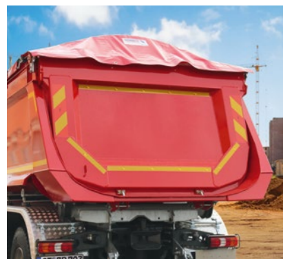
Innenliegende Pendelklappe mit Schütte für zentriertes Entladen.
