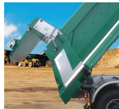
Ideal für abrasive und grobe Schüttgüter: hydraulische Rückwand .
