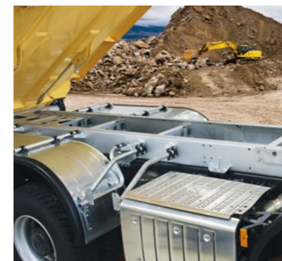
Der extrem torsionssteife Hilfsrahmen macht Fahrzeug und Aufbau zur hoch belastbaren, sicheren und effizienten Einheit.
