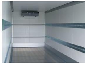
Die flüssigkeitsdichte Alu-Boden-wanne schützt vor Feuchtigkeit und Flüssigkeiten.
