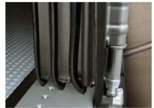
Vier-Lippen-Türdichtung für optimale Dichtigkeit des Koffer-aufbaus.
