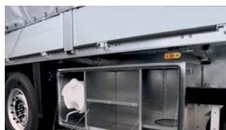
Опция: запираемый бокс для продуктов питания с водяным баком и держателем для газовой плитки.
