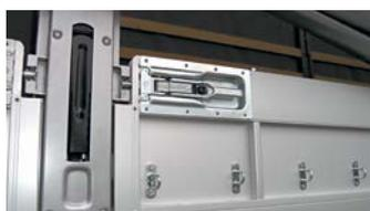
Борта из анодированного алюминия 620/720 мм с надежными запорами стяжного типа.
