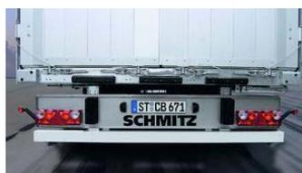
Задняя защита с болтовым креплением и кронштейн для фонарей из высококачественной стали.
