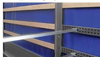
Идеальное крепление груза благодаря близко расположенным поперечным балкам.
