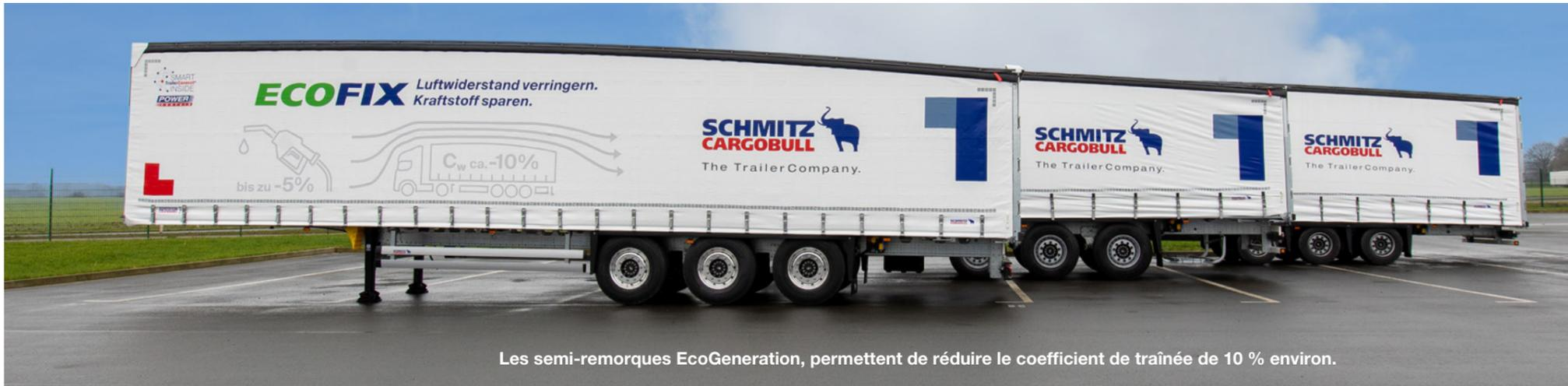
Les semi-remorques EcoGeneration, permettent de réduire le coefficient de traînée de 10 % environ.
