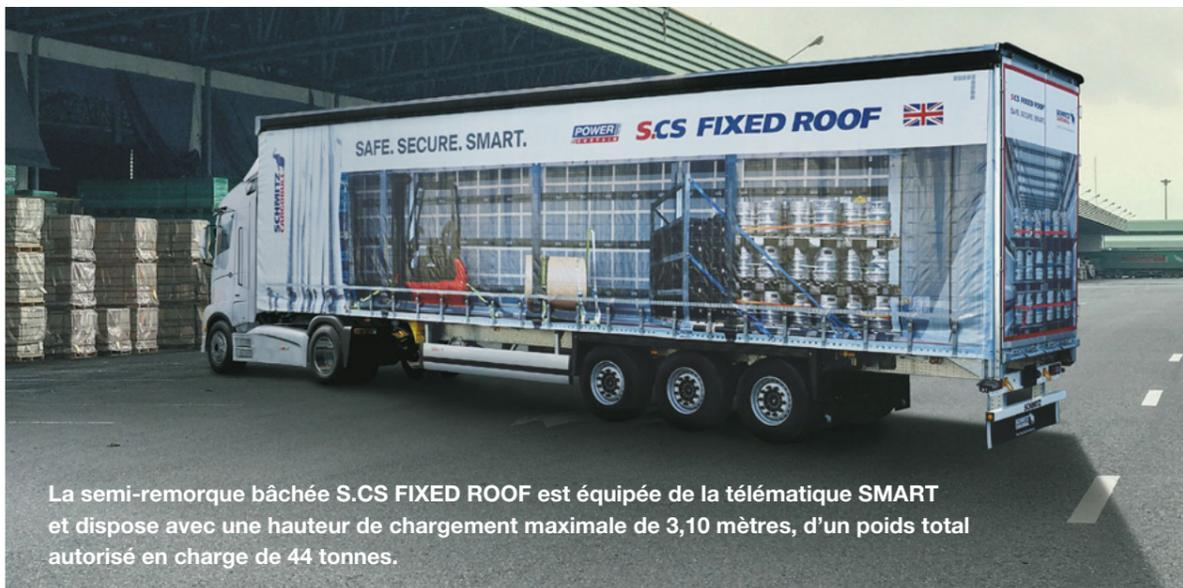
La semi-remorque bâchée S.CS FIXED ROOF est équipée de la télématique SMART et dispose avec une hauteur de chargement maximale de 3,10 mètres, d'un poids total autorisé en charge de 44 tonnes.
