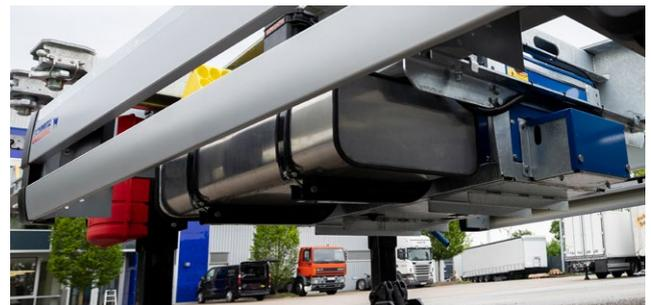
**130 l Dieseltank** für den mehrtägigen Dauerbetrieb von Kühlcontainern.
