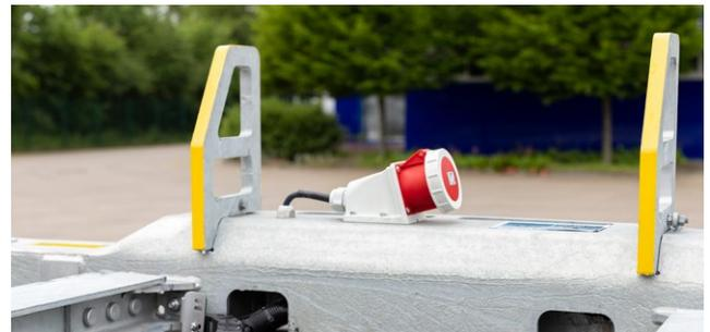
Einfaches Handling: Versorgung der Kühlcontainer über die **CEE Steckdose am Frontbalken**.
