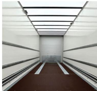
**Face avant en aluminium** avec plaque de protection en acier galvanisé pour une meilleure protection du chargement et de la remorque.
