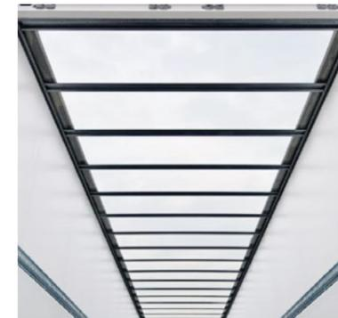
**Toit translucide:** Pour disposer de toute la luminosité extérieure pendant les mises à quai. En option : **Toit rigide plein**
