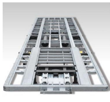
**Chassis roulé MODULOS:** Résistant à la corrosion et facile à entretenir grâce à sa galvanisation à chaud et à son assemblage boulonné.
