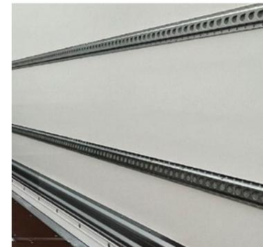
**Rails latéraux d'arrimage\*.** Pour protéger, caler et parfaitement arrimer le chargement. Nombre de rails et hauteurs de positionnement en option.
