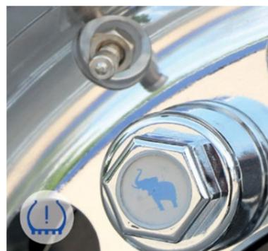
**Système de contrôle de la pression des pneus intégré TPMS :** La pression correcte des pneus réduit l'usure des pneus et diminue les coûts de carburant grâce à une meilleure résistance au roulement.
