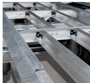
**Chassis roulé MODULOS :** Résistant à la corrosion et facile à entretenir grâce à sa galvanisation à chaud et à son assemblage boulonné.
