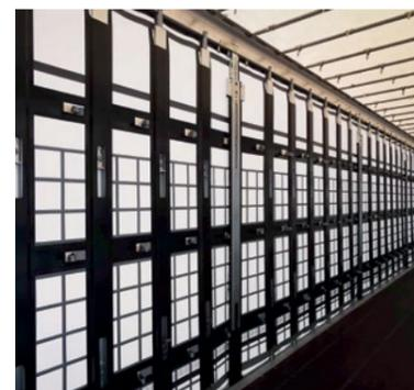
**POWER CURTAIN PLUS\* :** Système à baches latérales souples sans lattes de réhausse avec renforts intégrés spécialement certifié DIN EN 12642 Code XL et pour le transport de pneus.
