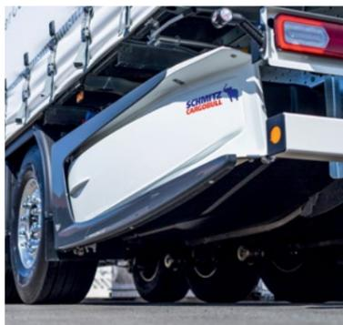
**Le coffre de rangement léger et aérodynamique\*** permet d'optimiser la circulation de l'air et contribue à de nouvelles économies de carburant. Le grand espace de rangement permet par exemple de stocker des palettes, des roues de secours, etc.
