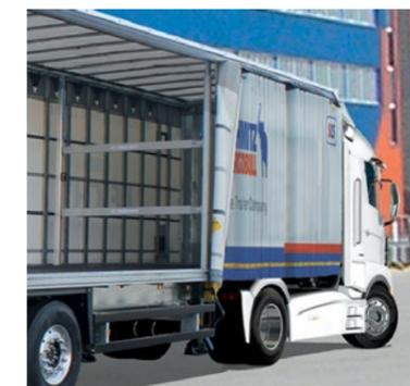
**SPEED CURTAIN\* :** Quelques secondes suffisent pour accéder au chargement grâce à la carrosserie à parois latérales souples coulissantes sans poteaux latéraux ni lattes de réhausse.
